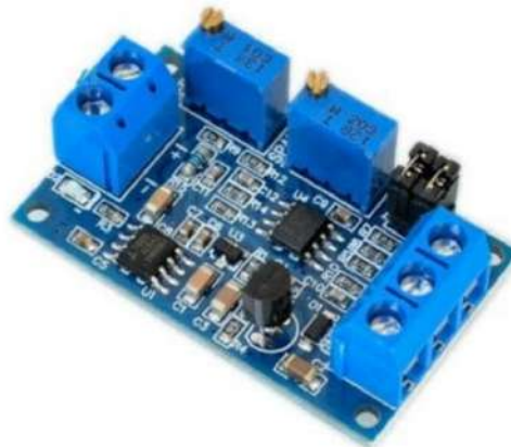
FIGURE 1.22 – Module convertisseur de courant – tension
