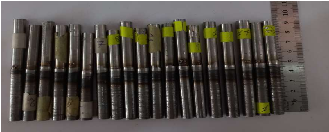
FIGURE 3.5 – Échantillons préparés pour l'inspection radiographique
