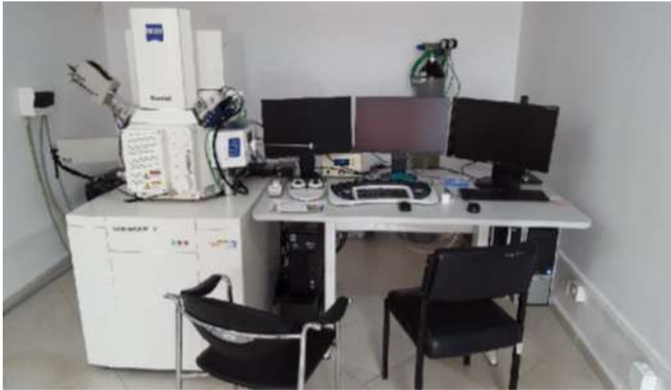
FIGURE 3.12 – Microscope électronique à balayage (Zeiss Gemini 300)
