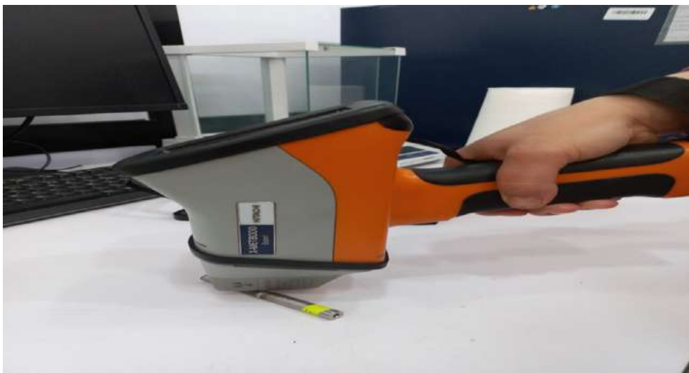
FIGURE 3.2 – Spectrométrie de fluorescence X
