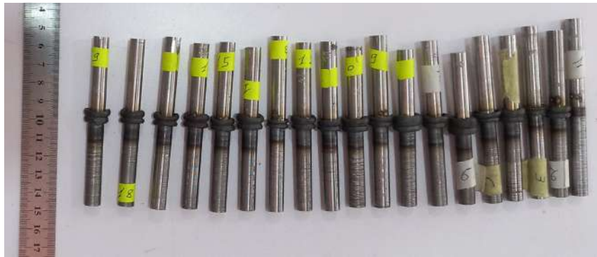
FIGURE 4.2 – Échantillons après soudage
