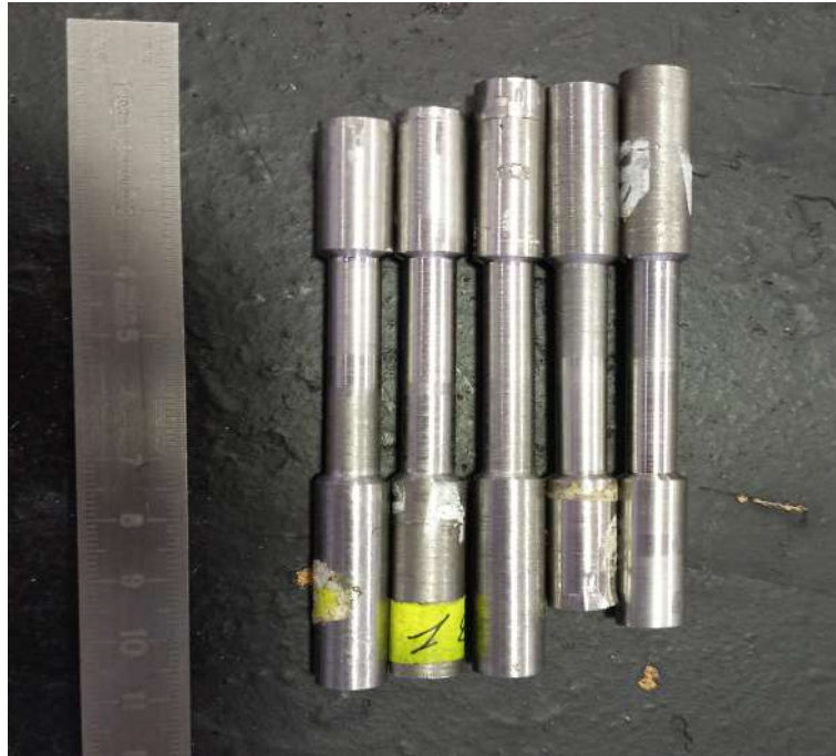
FIGURE 3.8 – Éprouvettes de traction
