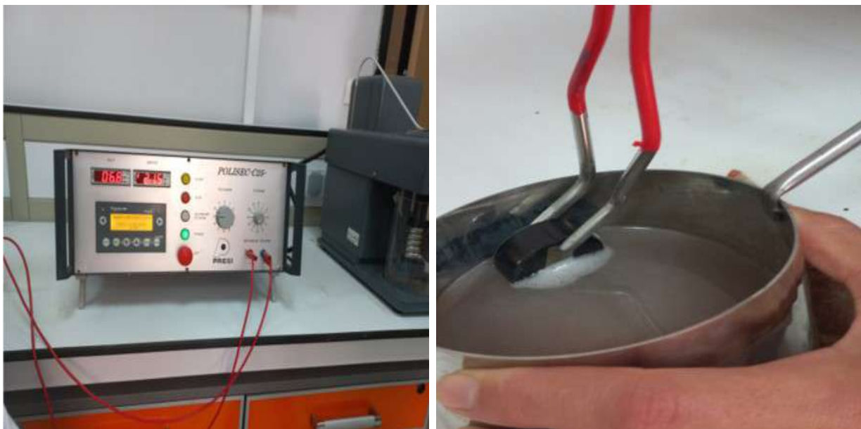
FIGURE 3.3 – Matériels utilisés pour l'attaque électrolytique
