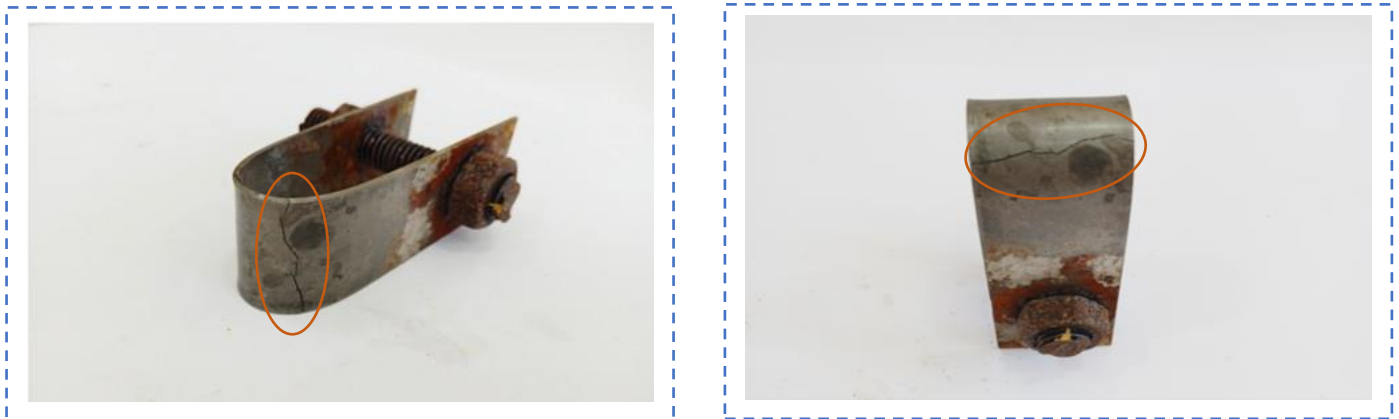
Figure IV. 20 : Fissuration très importante après une exposition de 118 heures
