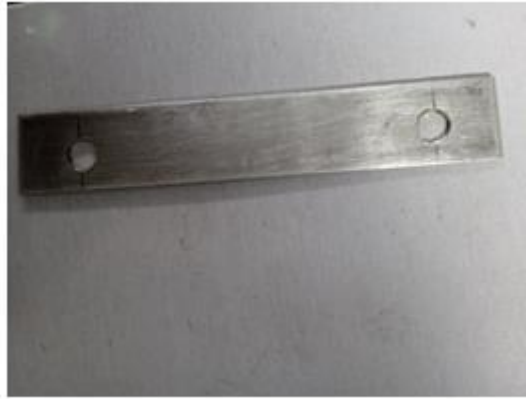
Figure III. 6 : Echantillon 304L après le décapage et le perçage
