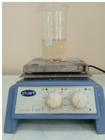
Figure III. 12 : L'essai de la corrosion sous contrainte ( MgCl_2 à 44%)
