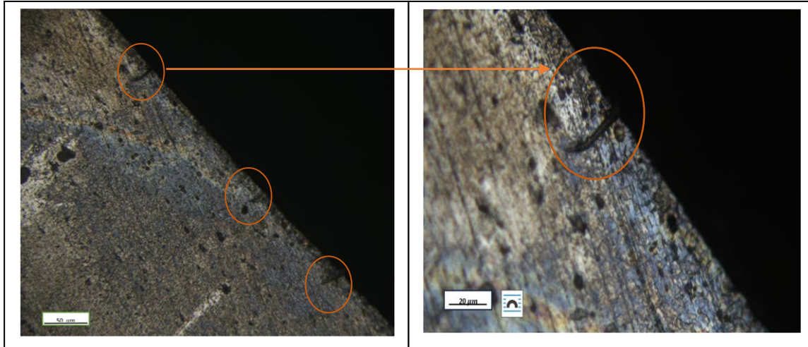
Figure IV. 11 : L'apparition des microfissures pour un temps d'exposition 24 heures
