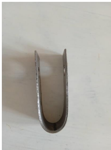
Figure III. 10 : Coude sous forme U en acier 304L
