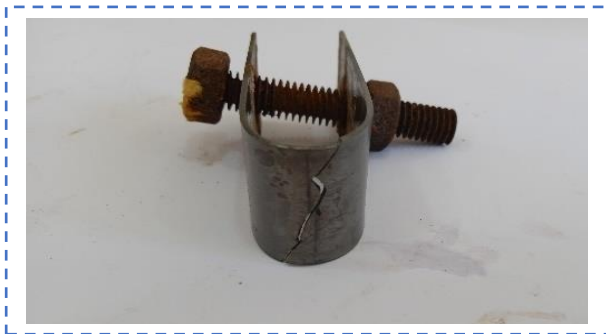
Figure IV. 22 : Rupture de la pièce après une exposition de 122 heures
