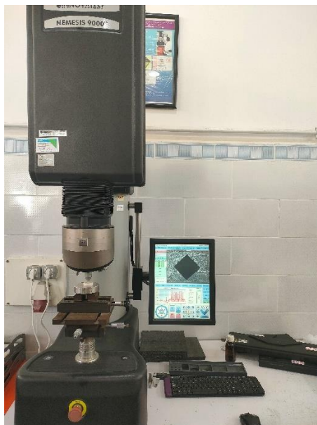
Figure III. 17 : Le duromètre de modèle INNVATEST NEMESIS 9000
