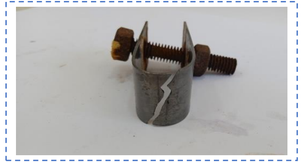
Figure IV. 22 : Rupture de la pièce après une exposition de 122 heures
