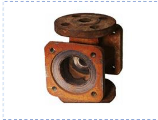
Figure II. 2 : Corrosion sèche d'une pièce en acier
