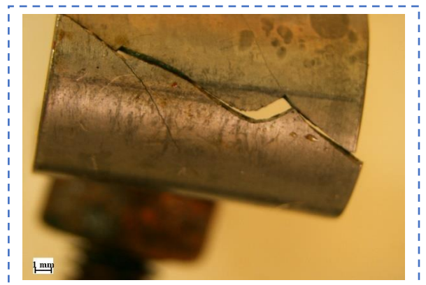
Figure IV. 23 : Rupture observer avec le macroscopie
