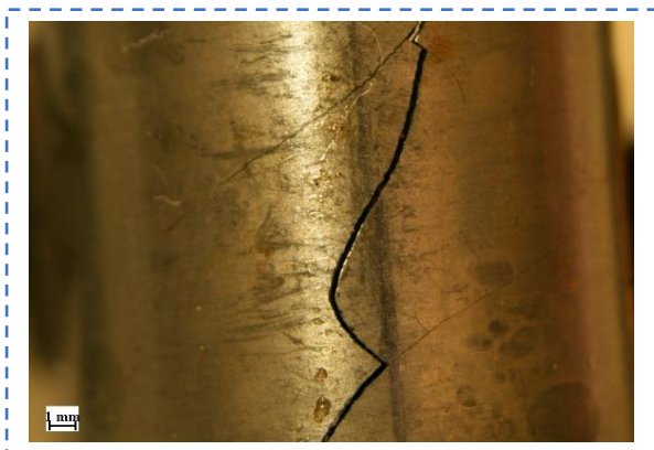
Figure IV. 23 : Rupture observer avec le macroscopie
