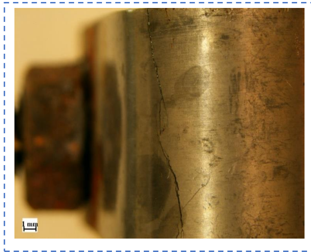
Figure IV. 21 : Fissuration observée par le macroscopie après une exposition de 118 heures
