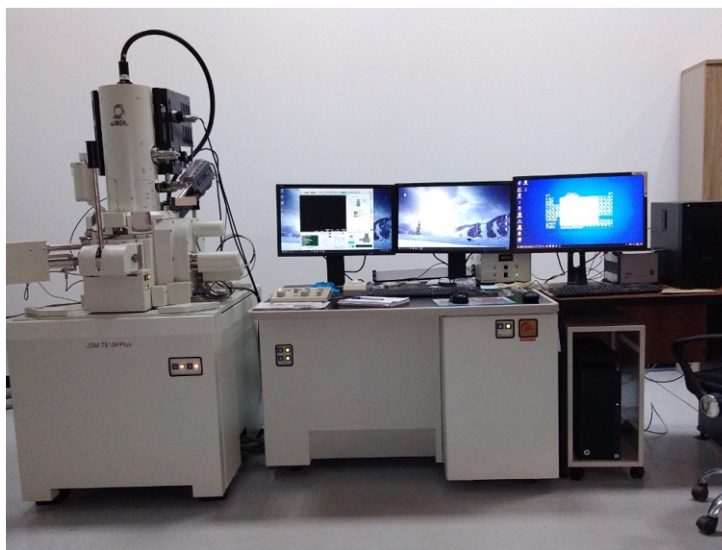
FIGURE 3.21 – Le MEB EOL JSM-7610FPlus utilisé au CRTSE
