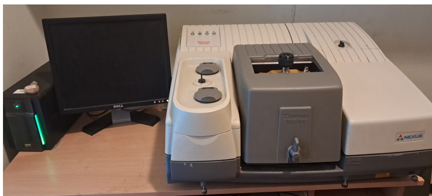
FIGURE 3.17 – L'appareil Thermo-Nicolet-Nexus pour l'étude du FTIR utilisé à CRTSE
