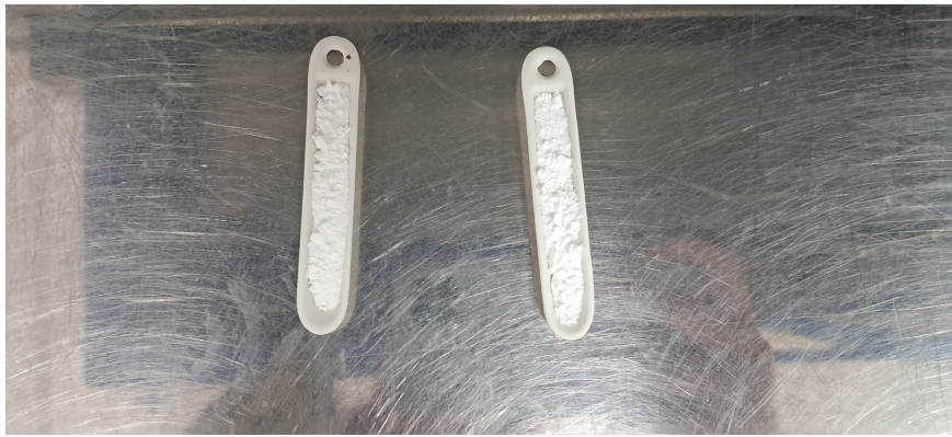
FIGURE 3.10 – Creusets en ceramique utilisés pour les recuits
