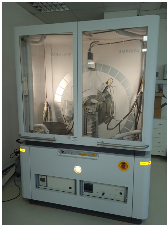
FIGURE 3.18 – DRX Malvern Panalytical Empyrean utilisé au Plateau Technique d'Analyses Physico-Chimiques de l'USTHB
