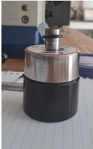
FIGURE 3.14 – Moule utilisé pour le compactage
