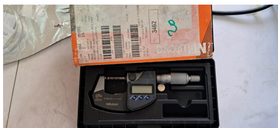
FIGURE 3.27 – Micromètre numérique Mitutoyo (modèle 293-240) utilisé par CRTSE
