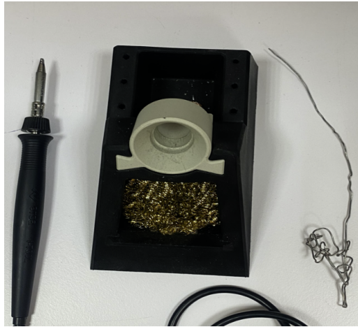
FIGURE 3.32 – Fer à souder et du laiton
