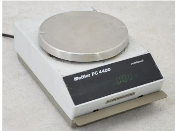
*Figure 3-1 : Balance Mettler PC4400*
