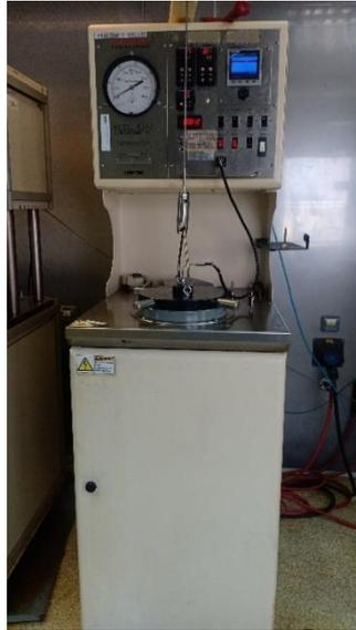
*Figure 4-10 : Consistomètre pressurisé Chandler Modèle 8340*
