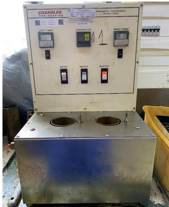
Figure 3-3 : Consistomètre atmosphérique (SLB)
