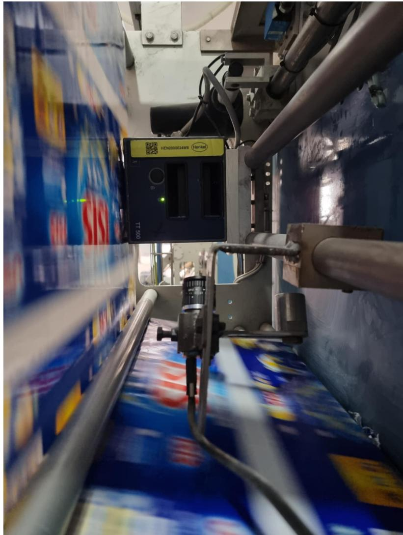
FIGURE 3.1 – Position de la caméra dans la ligne volpack
