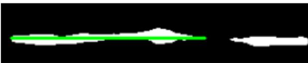
FIGURE 3.23 – Détection d'un scellage incorrect
