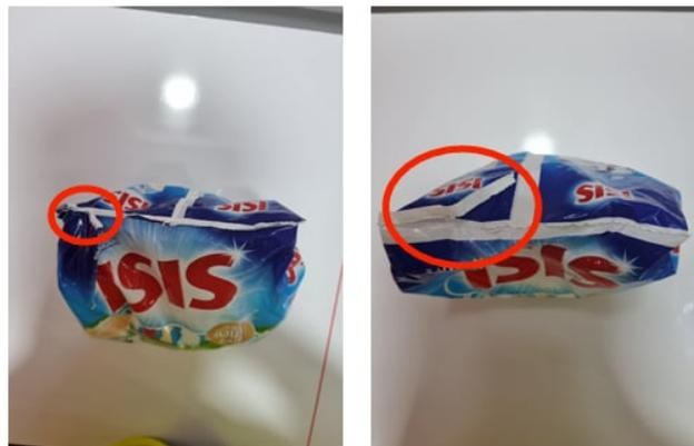
FIGURE 1.11 – figure représentatif des défauts de scellage
