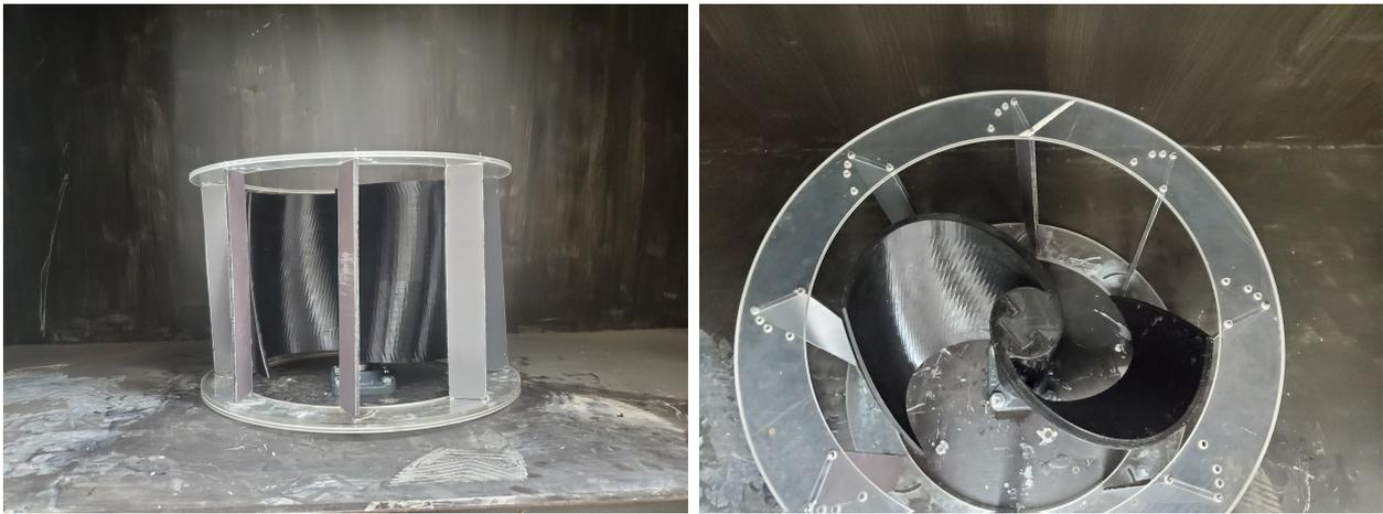
FIGURE 4.16 – Installation du rotor et le stator
