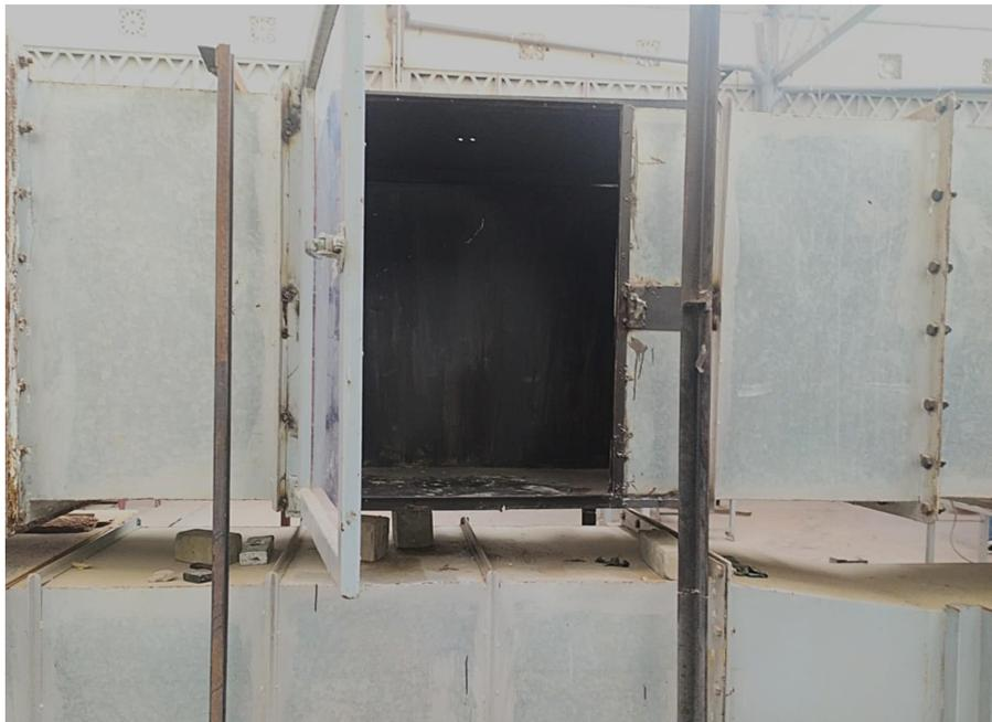
FIGURE 4.14 – La section d'essai de la soufflerie
