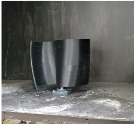
FIGURE 4.11 – Rotor fixé dans la soufflerie
