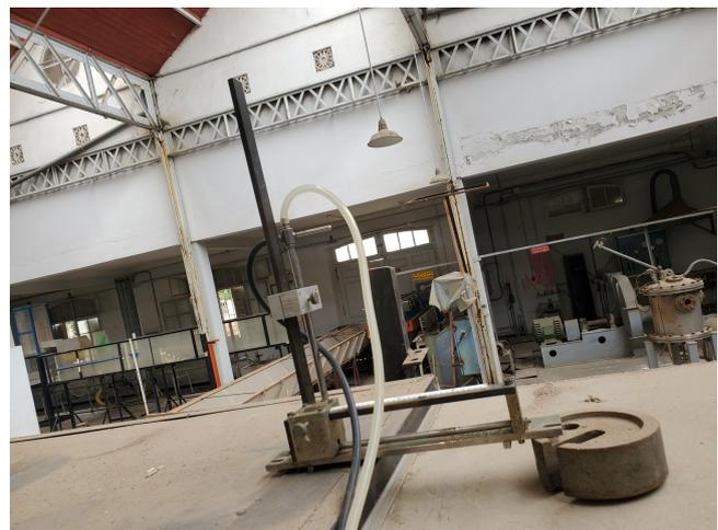
FIGURE 4.12 – Installation du tube de pitot
