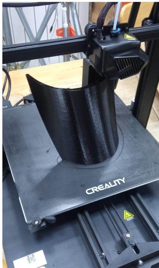
FIGURE 2.6 – Impression du rotor
