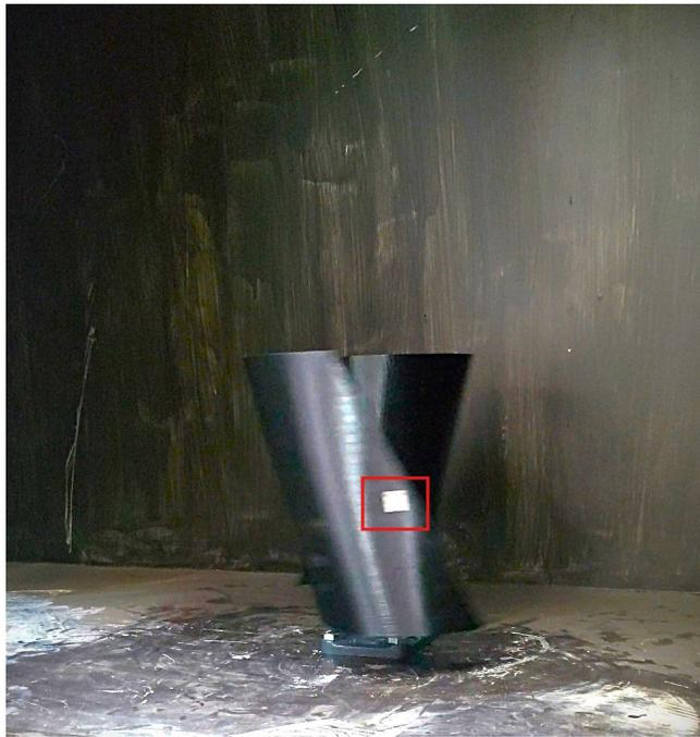
FIGURE 4.13 – Le réflecteur infrarouge collé sur l'aube
