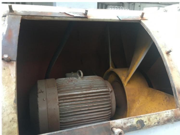
FIGURE 4.3 – Moteur et ventilateur de la soufflerie [1]
