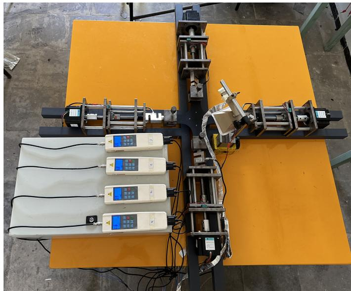
FIGURE 4.1 – Montage final de la machine de traction biaxiale
