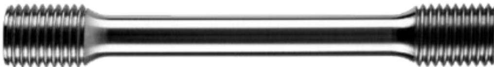
FIGURE 1.8 – Éprouvette filetée
