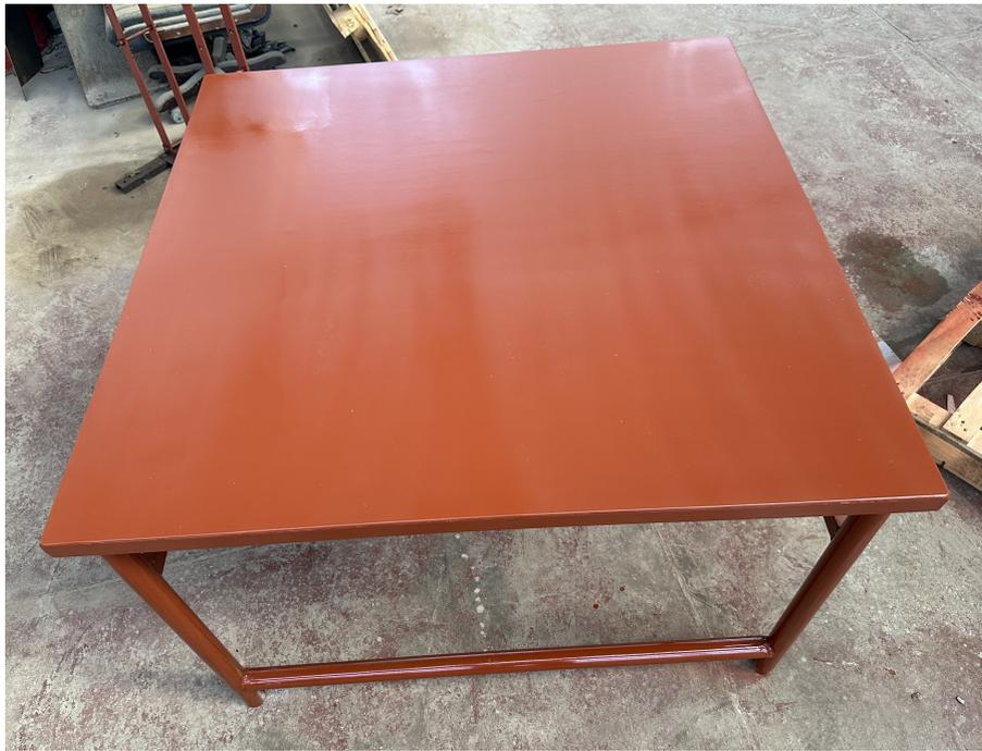
FIGURE 2.15 – La table avec une couche d’antirouille
