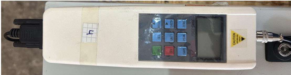
FIGURE 3.15 – Décodeur du capteur HF-5K
