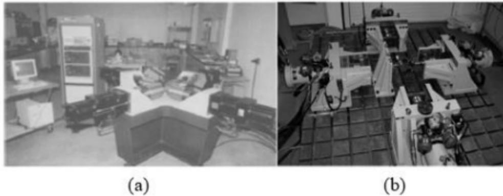
FIGURE 1.17 – Machines d’essai biaxiales avec quatre actionneurs développées par : (a) Makinde/Green [18] et (b) Gower [19]
