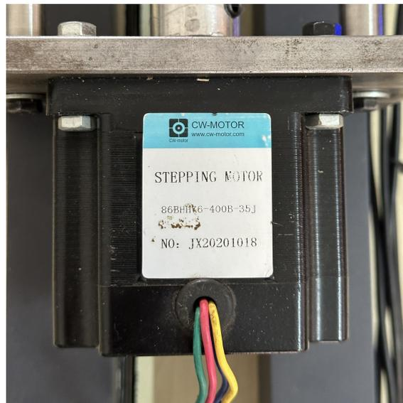
FIGURE 3.3 – Moteur pas à pas (86BHH76-400B-35J) fabriqué par CW-motor
