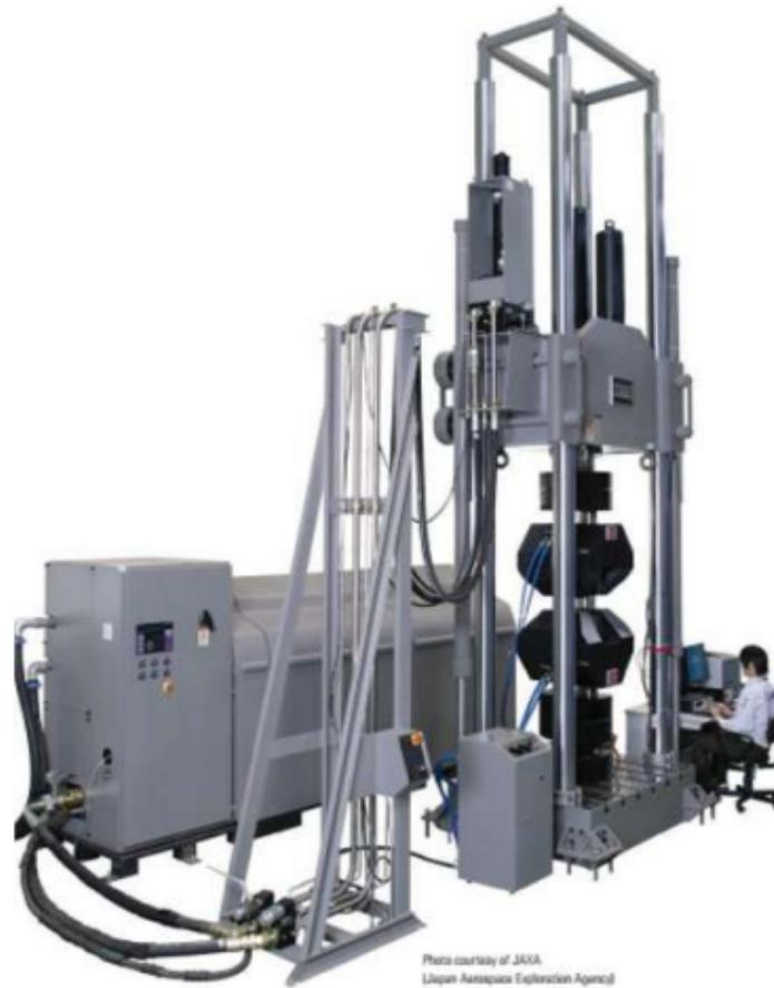
FIGURE 1.2 – Machine de traction de capacité supérieure à 30MN
