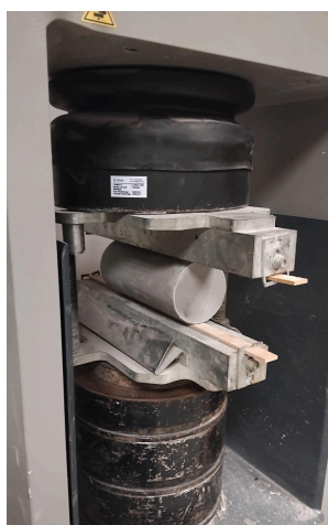
Figure 4.15 : Essai de fendage sur éprouvette 70 x 160
