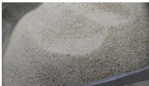
Figure 4.22 : Sable Blanc utilisé (0 - 1,25 mm), Afroquartz, Tébessa
