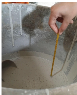
Figure 4.11 : Mesure de la température du béton
