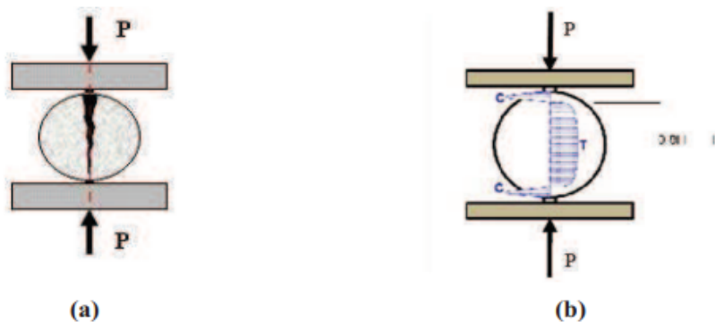
Figure 4.14 : Essai de fendage (a) Schéma de principe (b) Diagramme des contraintes dans la section de l'éprouvette
