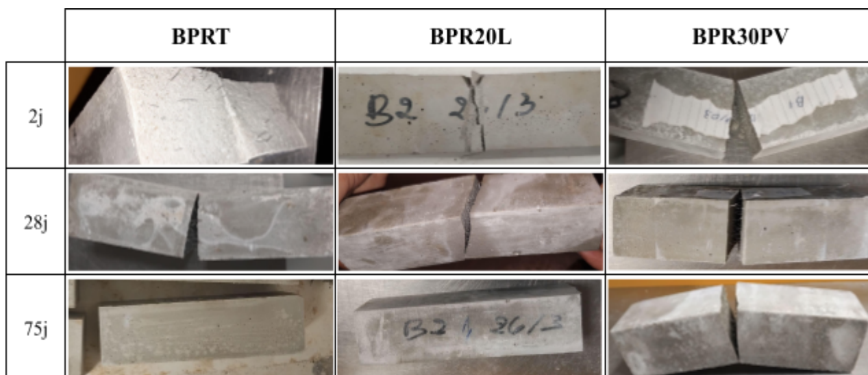
Figure 6.5 : Fissures causées par l'essai de flexion sur les éprouvettes prismatiques 3 bétons (4x4x16 cm 3 ) à 2j, 28j et 75j
