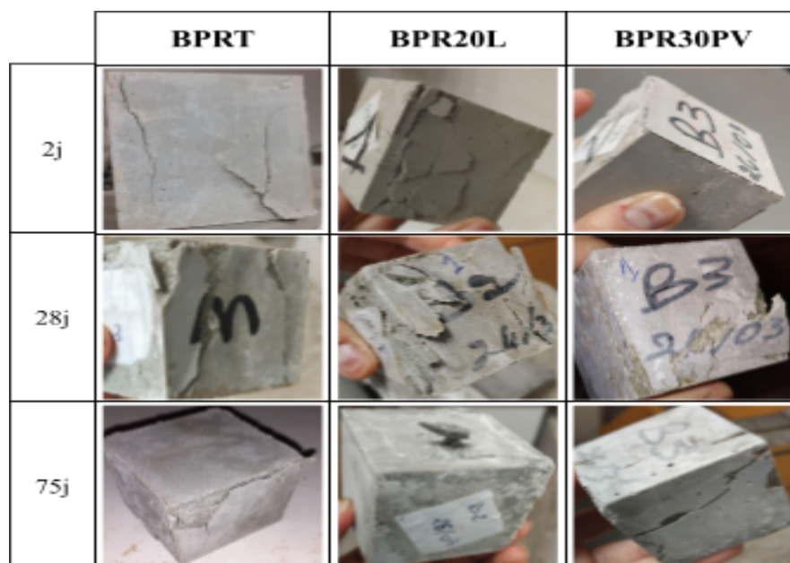
Figure 6.3 : Fissures causées par l'essai de compression sur les éprouvettes cubiques des 3 bétons (5x5x5 cm 3 ) à 2j, 28j et 75j
