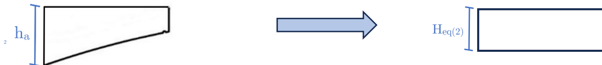
Figure III-11 Hauteur équivalente de la section 2 de l'encorbellement
