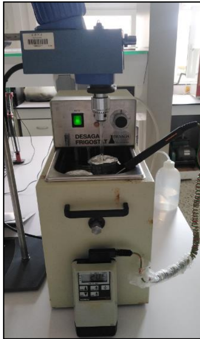
Figure 20 : Système d'extraction de la lignine ; bain thermostaté, thermomètre et dispositif d'agitation mécanique munie d'une tige en verre.
