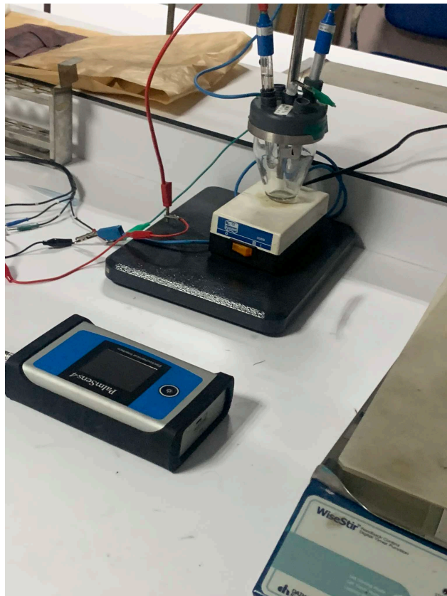
Figure. 2.10 : Branchement du potentiostat à la cellule électrochimique à trois électrodes
