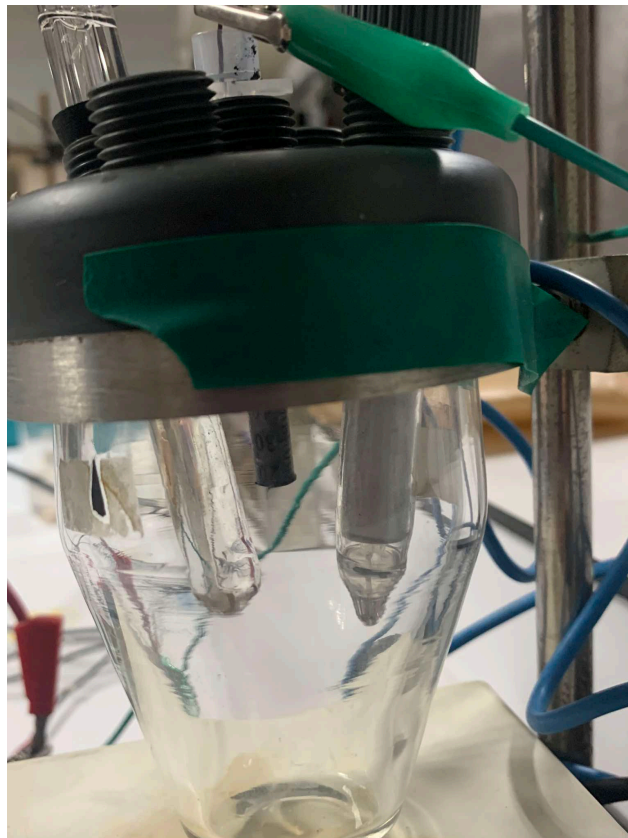
Figure. 2.9 : Aménagement d'une cellule électrochimique à trois électrodes
