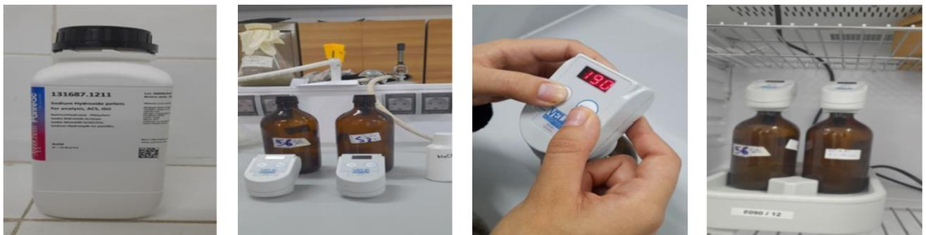
**Figure II.11 :** DBO mètre «FTC 120 Cooled incubator- VELP scientifica ».
