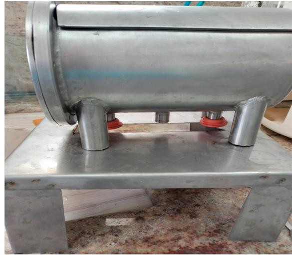
**Figure II.3 :** Un appareil de filtration rotatif
