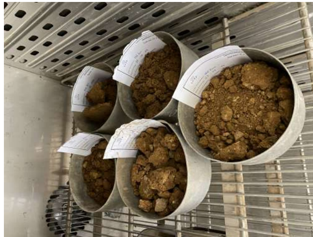
FIGURE 2.11 – Échantillons de sol étuvés pour déterminer la teneur en eau
