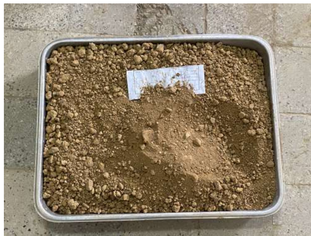
FIGURE 2.9 – Échantillon de sol après séchage à l'étuve avant tamisage
