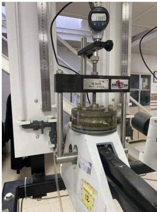
FIGURE 2.21 – Cellule œdométrique placée sur le cadre de chargement et mise en contact avec le comparateur.
