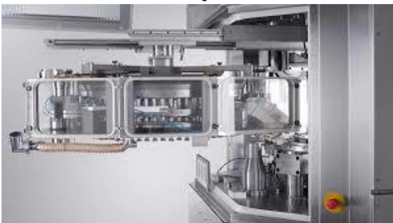
Figure 4.5 : Vue d'ensemble sur la machine de compression (Document interne GSK)
