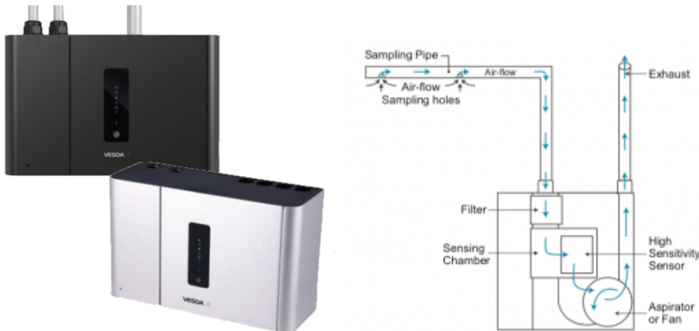
Figure 3.5 : Détection par aspiration - Principe de fonctionnement
