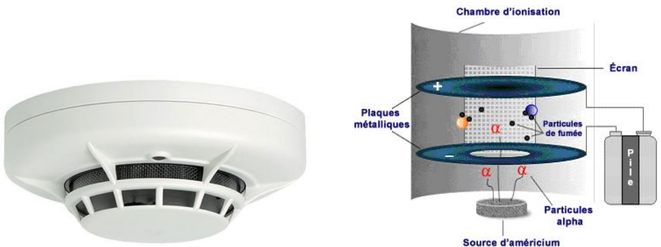
Figure 3.2 : Détecteur ionique et son principe de fonctionnement.
