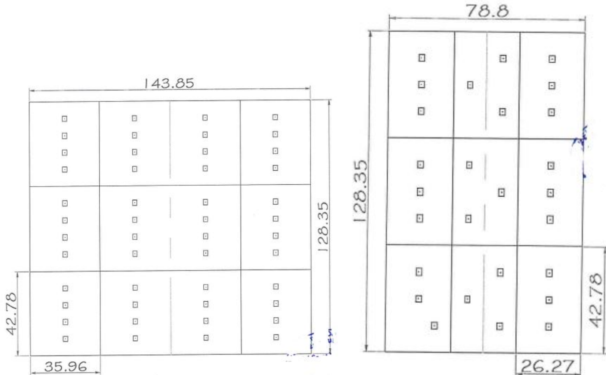
Figure 2.6 : Emplacement des dômes dans les deux surfaces
