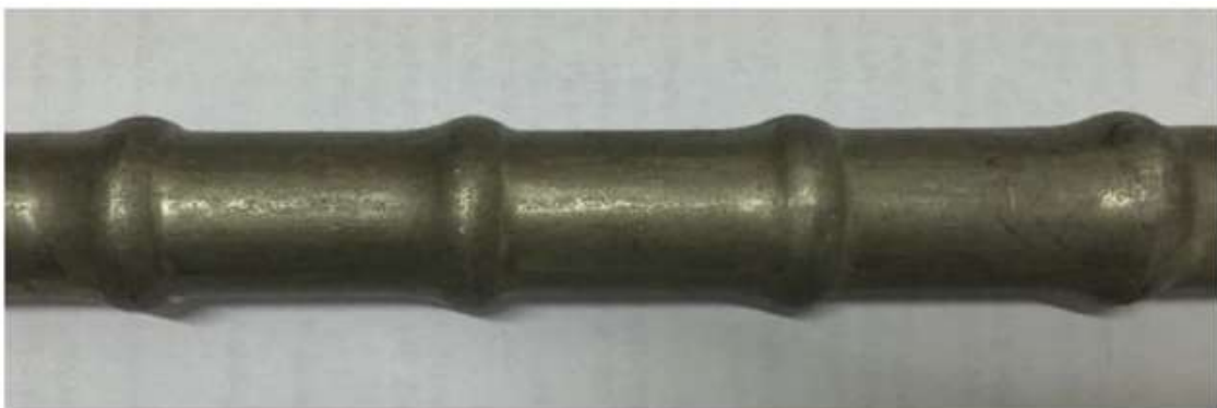
Fig. V-11. Tube ondulé asymétrique convexe vers l'extérieur [76]
