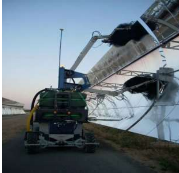
Figure II-12 : Robot « Paris » de nettoyage automatique de SENER [41]
