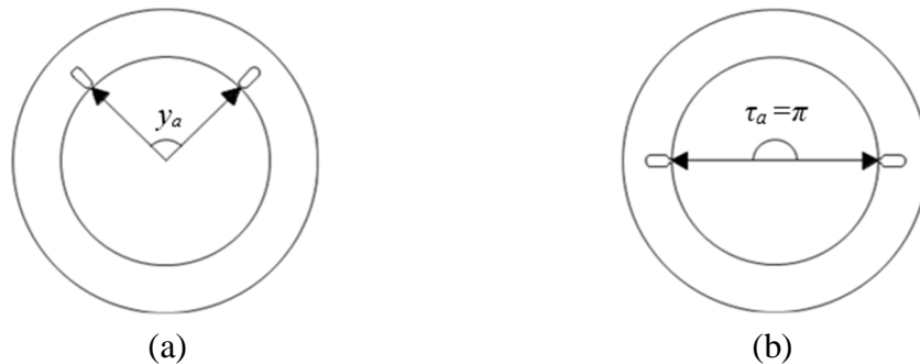
Fig.4.9 Bobine statorique à P=1 (a) Bobine à pas raccourci y < \tau_p (b) Bobine à pas diamétral y = \tau_p
