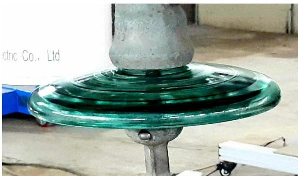
Figure II. 1 Isolateur réel 1512 L.
