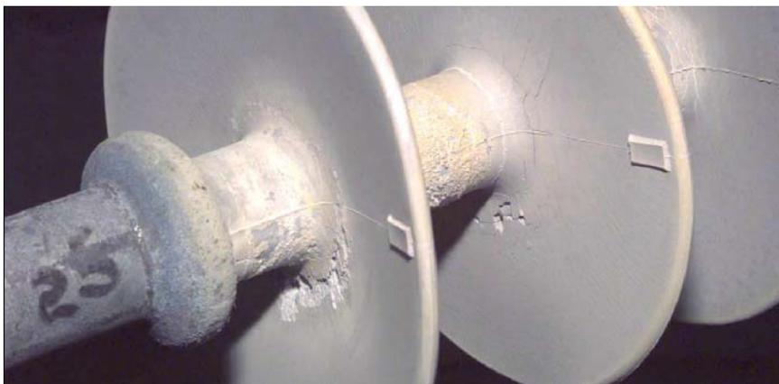
Figure I. 8 Observation de la détérioration à proximité de la partie haute tension après cinq ans de vieillissement accéléré. [54].
