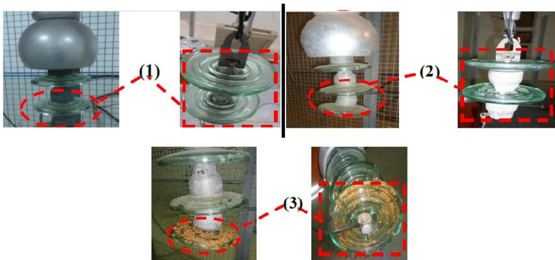
Figure I. 3 Chaîne d'isolateurs (1) propre, (2) humide, (3) polluée [49].
