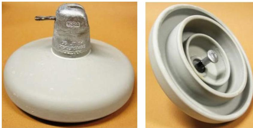
Figure I. 7 Revêtement de RTV appliqué à la surface de l'isolateur en verre capot et tige [51].
