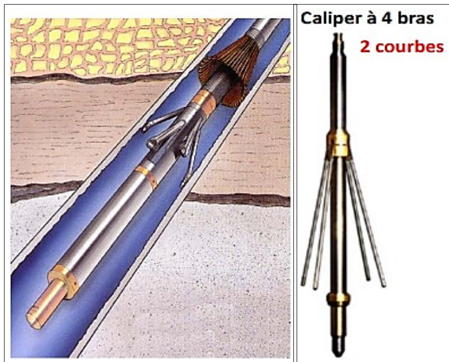
FIGURE 3.12 – Schéma d'outil Caliper à 4 bras [18]
