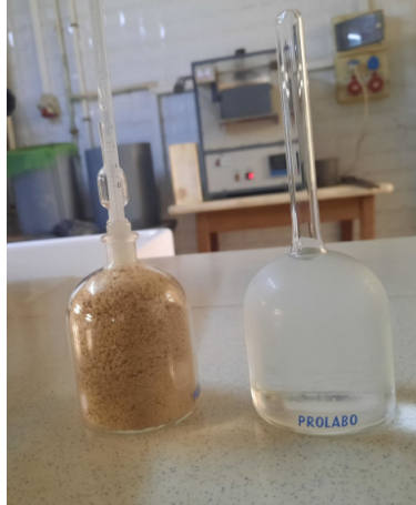
FIGURE 2.12 – Le pycnomètre Prolabo utilisé pour mesurer le volume des vides
