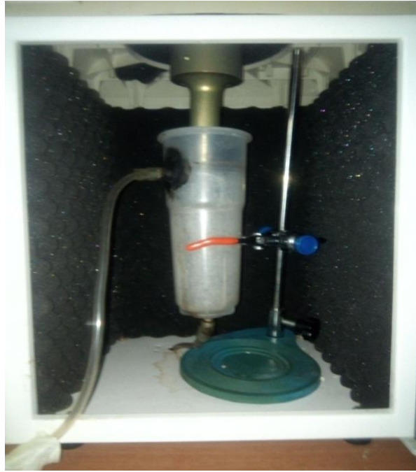
Figure 17: Dispositif expérimental de traitement des margines brutes par Ultrasons
