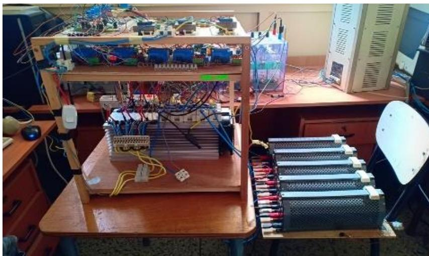
Figure 3.3. Banc d'essai du 5PH-IMC
