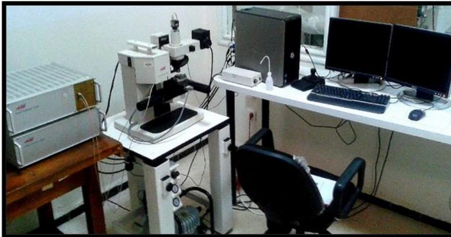
**Figure 7 :** Appareil de nanoindentation CSM.
