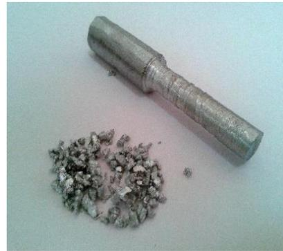
Figure III.2 : Grains de matière (chariotage)
