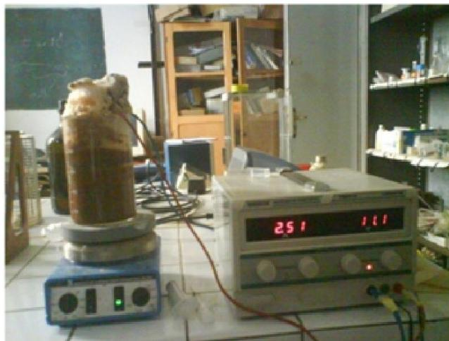
**Figure II- 8** : Schéma et photo du dispositif expérimental.(1) bécher, (2) filtre, (3) électrodes, (4) barreau magnétique, (5) agitateur magnétique, (6) générateur électrique, (7) câble électrique.
