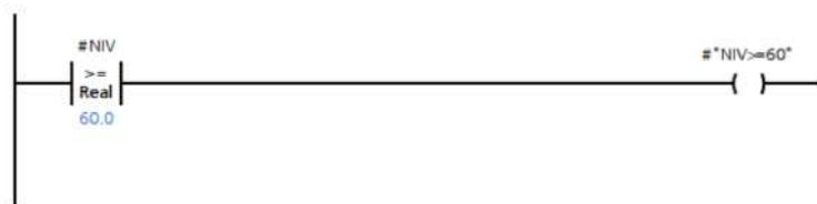
FIGURE B.40 – exemple comparateur de NIVEAU
