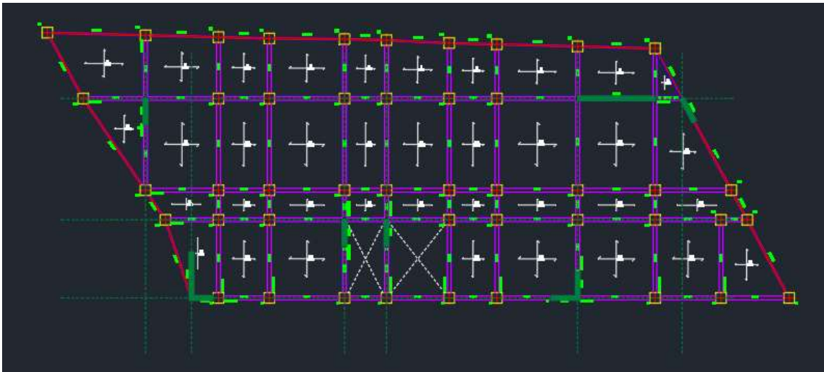
Figure 1-5 : Plan de coffrage de l'Entresol
