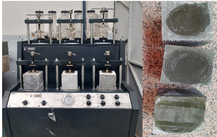
Figure 4.15 : Essai perméabilité à l'eau
