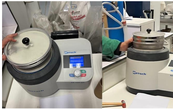
Figure 4.7 : Refus sur tamis 45 \mu\text{m}
