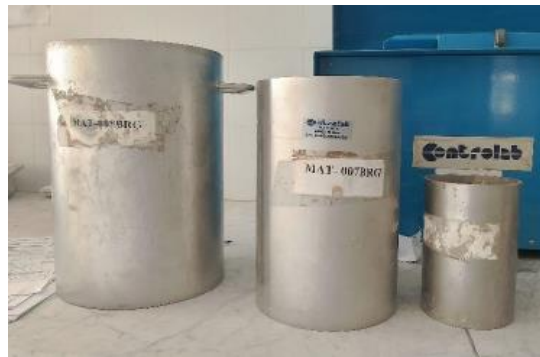
Figure 4.9 : Masse volumique sur béton frais
