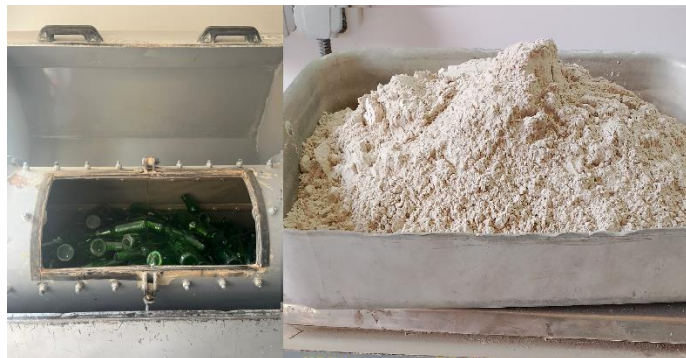
Figure 4.6 : Broyeur à boulets
