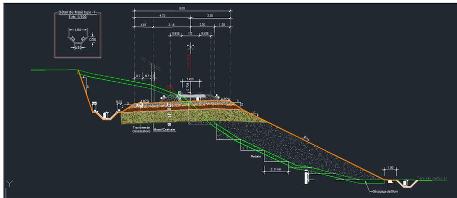
FIGURE 5.5 – Différents réseaux d’assainissement longitudinaux [16]
