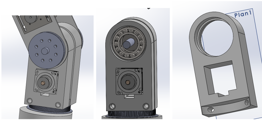
FIGURE 2.7 – Modélisation de la 1ère articulation du bras manipulateur
