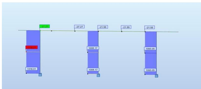
Figure III. 54 : effort normal sous le poids du tablier a ELU
