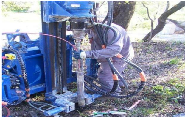
**Figure I. 9 :** Essai préssiométrique
