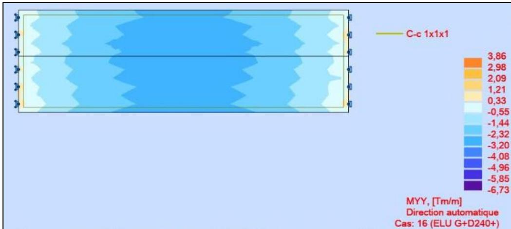
Figure IV.22. Moment max et min de l'hourdis (ELU)
