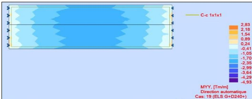
Figure IV.23. Moment max et min de l'hourdis (ELS)
