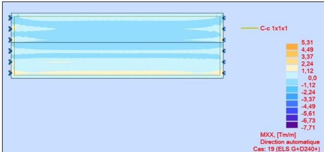
**Figure IV.21.** Moment max et min de l'hourdis (ELS)
