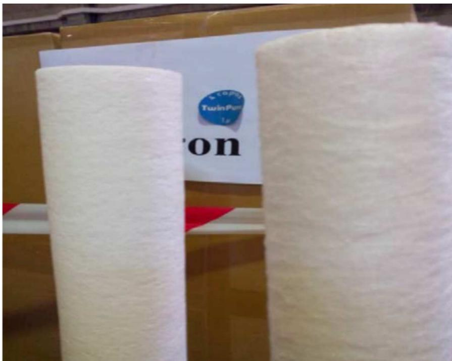
FIGURE 2.6 – Les filtres à cartouche utilisés dans la station de Fouka.
