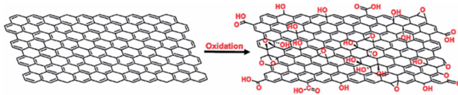
FIGURE I.4 – Oxydation d’une feuille de graphène pour former l’oxyde de graphène montrant l’introduction des groupes fonctionnels oxygénés.
