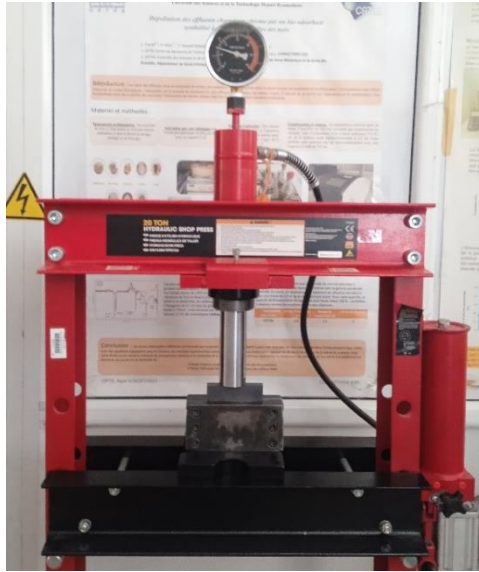
Figure II.5. Presse hydraulique avec moule rectangulaire de flexion
