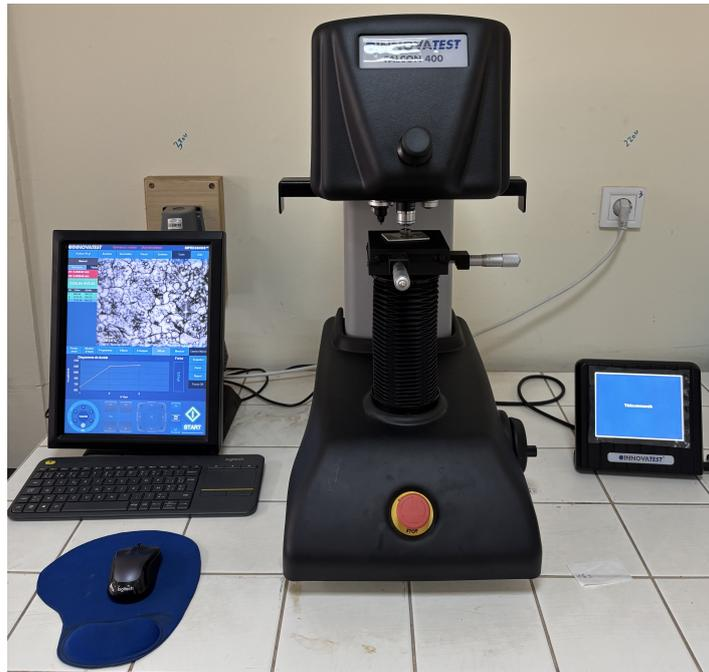
FIGURE 3.23 – Photo du microduromètre INNOVATEST Falcon 400 utilisé.
