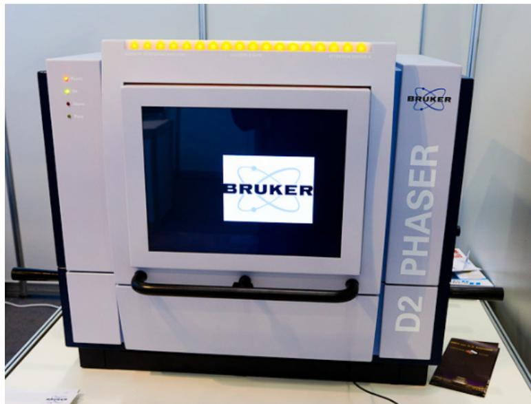
FIGURE 3.22 – Photo de l'appareil de DRX utilisé.
