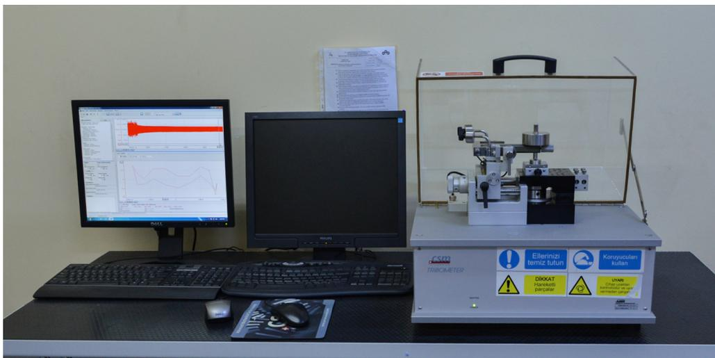
FIGURE 3.24 – Photo du tribomètre utilisé.
