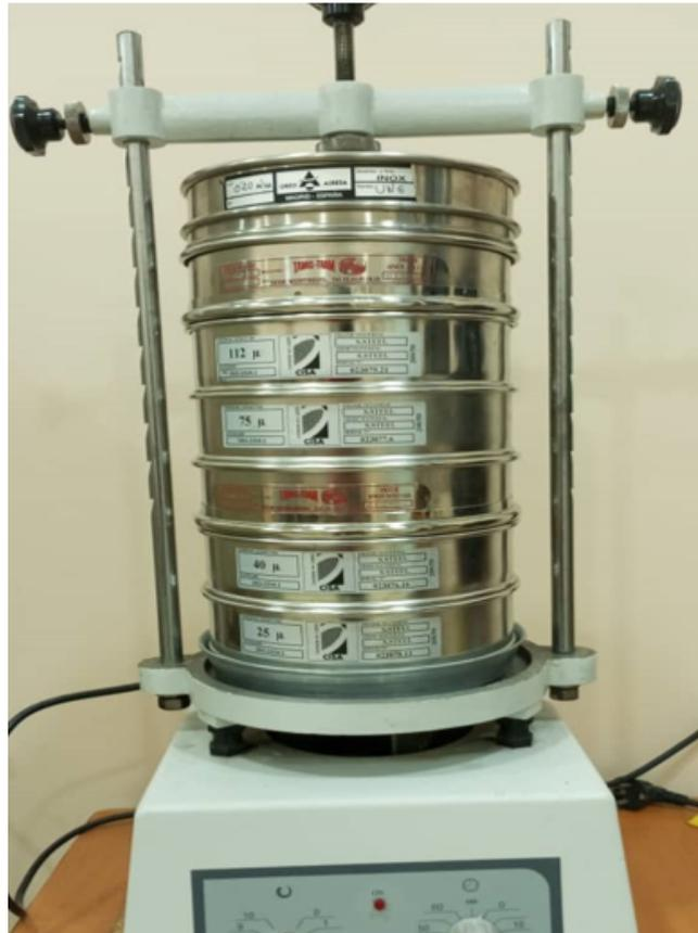
FIGURE 3.1 – Photo de la tamiseuse utilisée.
