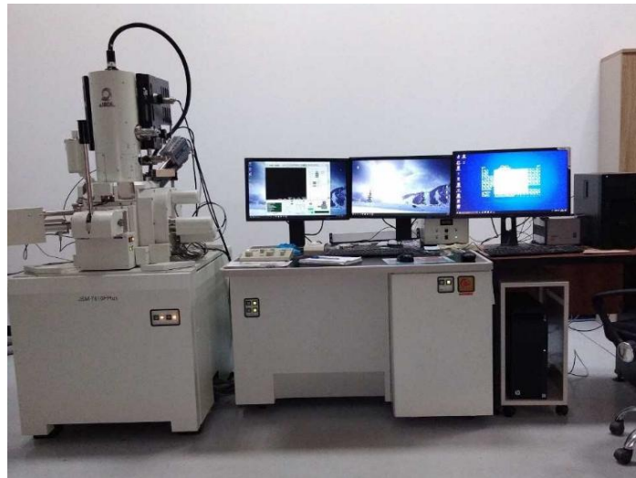
Figure 2- 14 : Microscope Électronique à Balayage de haute résolution (MEB) JSM-7610F Plus (CRTSE).
