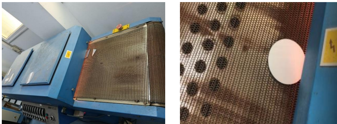
Figure 2-9 : Four de séchage utilisé au CRTSE.
