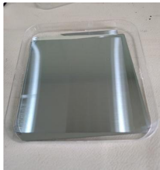
Figure 2-1 : Plaquette de silicium préparée au CRTSE.
