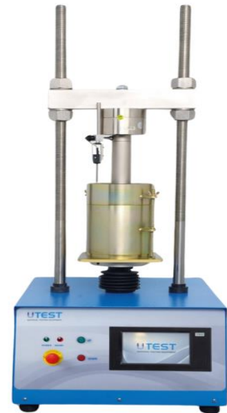
Figure 1.18 : Presse de poinçonnement CBR automatisée
