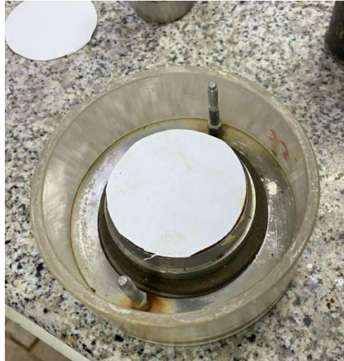
Figure 2.30 : Préparation de la cellule œdométrique
