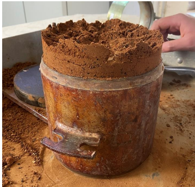
Figure 2.18 : L'échantillon à la fin de compactage
