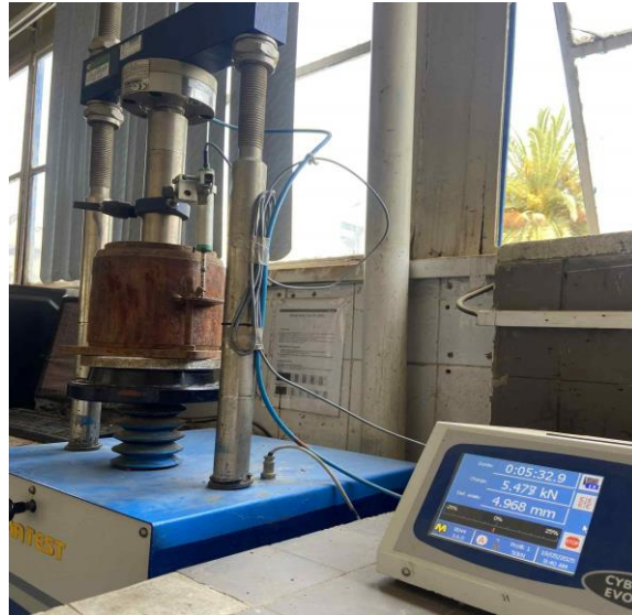
Figure 2.25 : Poinçonnement de l'échantillon
