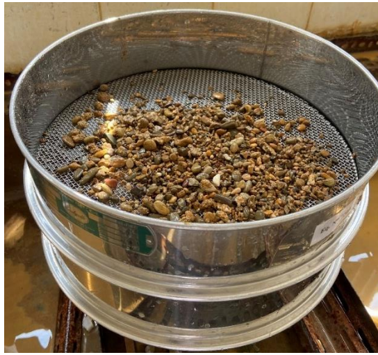
Figure 2.7 : Lavage des fines (Tamis 2mm et 0,063mm)
