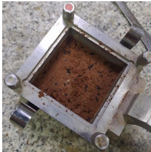
Figure 2.33 : Préparation de l'échantillon pour l'essai cisaillement
