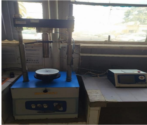
Figure 2.23: Presse de compression utilisée pour le poinçonnement
