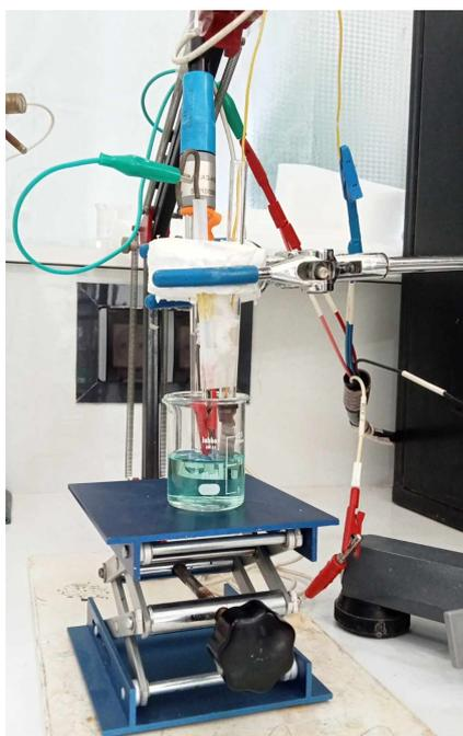
Figure 2.9 Schéma du dispositif électrochimique utilisé pour l'électrodéposition de couches de transport de trous.
