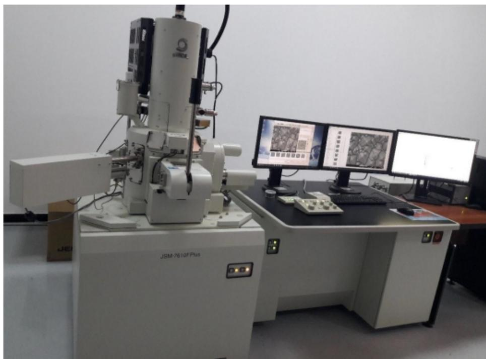
Figure 2.14 Microscope électronique à balayage JEOL.
