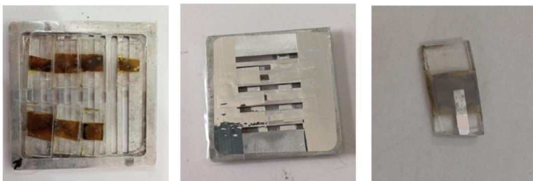
Figure 2.12 Dépôt d'aluminium.
