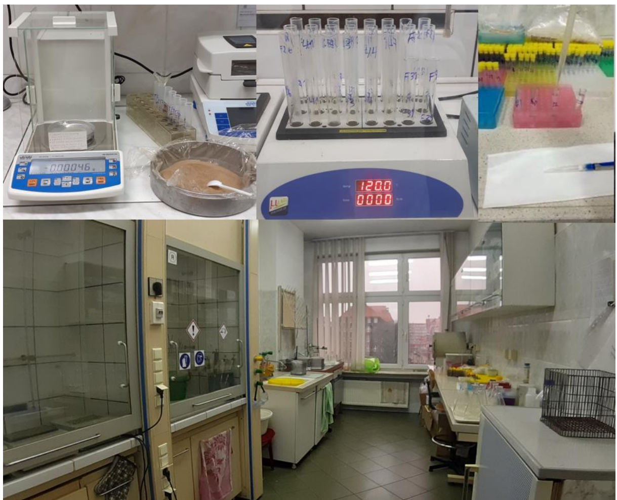
Figure 2.1.7: Procédures de déminéralisation de Nerium oleander L., par digestion à l'aide de l'acide nitrique ( \text{HNO}_3 ).
