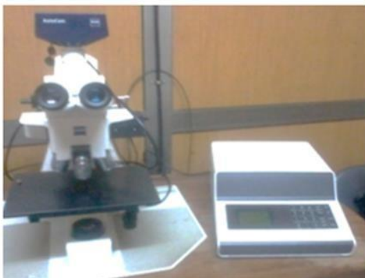
Figure III. 10: Microduromètre semi-automatique à gauche et Exemple d'une empreinte de la Micro-dureté à droite
