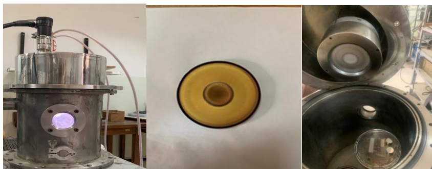
Figure II. 4: Vue de l'extérieur et de l'intérieur de l'enceinte de dépôt.
