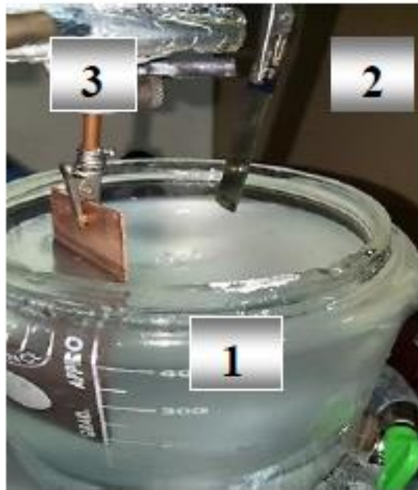
Figure II. 5: cellule l'anodisation : 1-Cellule, 2-Electrode travail TA6V4 (anode), 3-Electrode cuivre (cathode).
