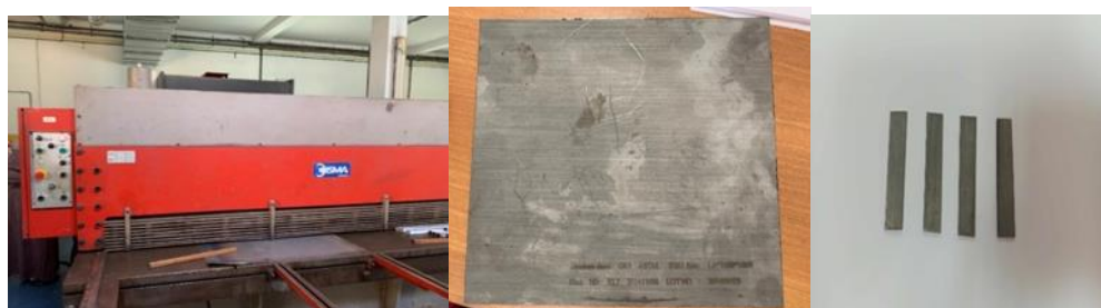
Figure II. 1: Découpage des échantillons avec la guillotine.
