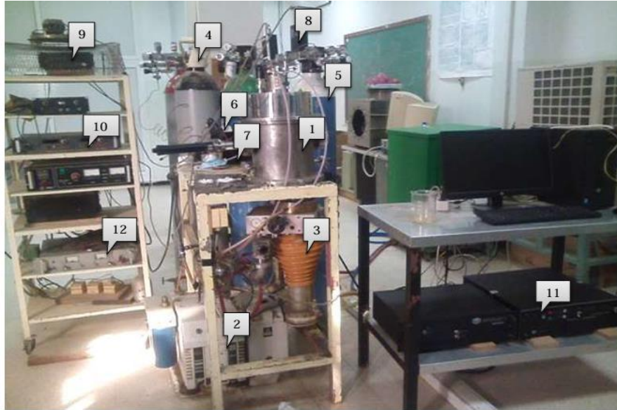
Figure II. 3: Dispositif expérimental de pulvérisation Magnétron HIPIMS.
