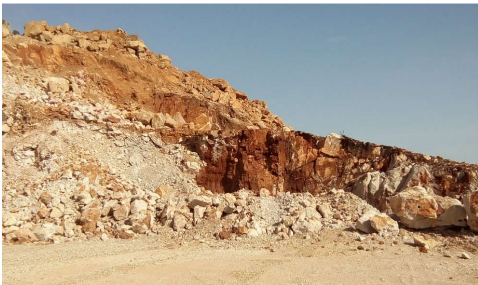
Figure 3.10: Couverture de la partie supérieure de la carrière de Djebel Bouzegza à décaper.
