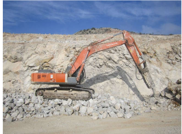
Figure 3.12: Utilisation de brise-roche pour la réduction de taille des roches abattues dans la carrière de Djebel Bouzegza.
