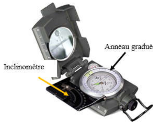
Figure 4. 1: La boussole utilisé pour déterminer l'orientation et le pendage du plan de la discontinuité.
