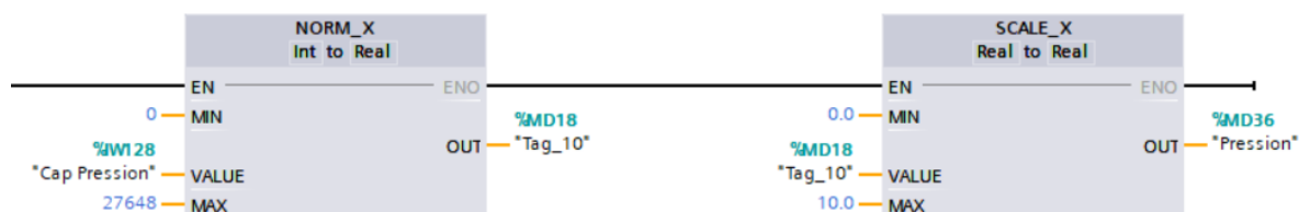
FIG. 3.15 : Traitement de la pression dans TIA Portal
