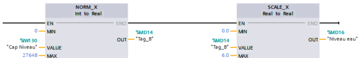
FIG. 3.11 : Programme du traitement de la valeur analogique du réservoir d'aspiration
