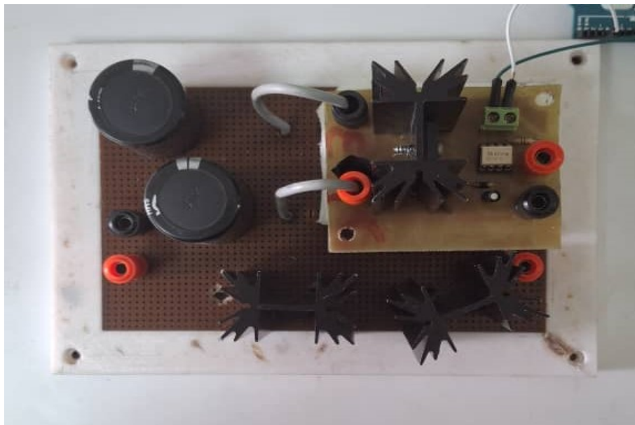
FIGURE 4.17 – Montage finale de hacheur Boost
