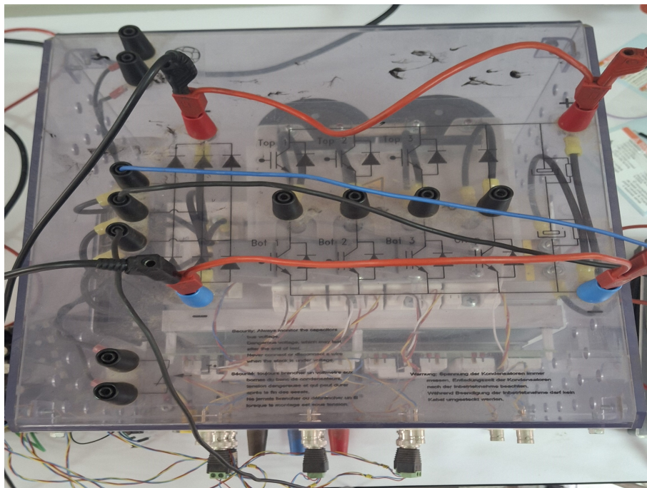
FIGURE 4.23 – Redresseur utilisé du laboratoire d'électronique de puissance
