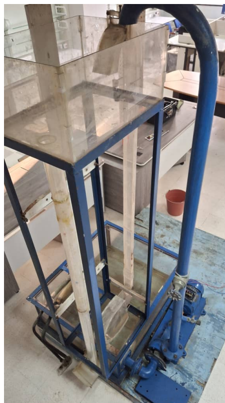
FIGURE 3.23 – Aperçu supérieur du circuit hydraulique finalisé
