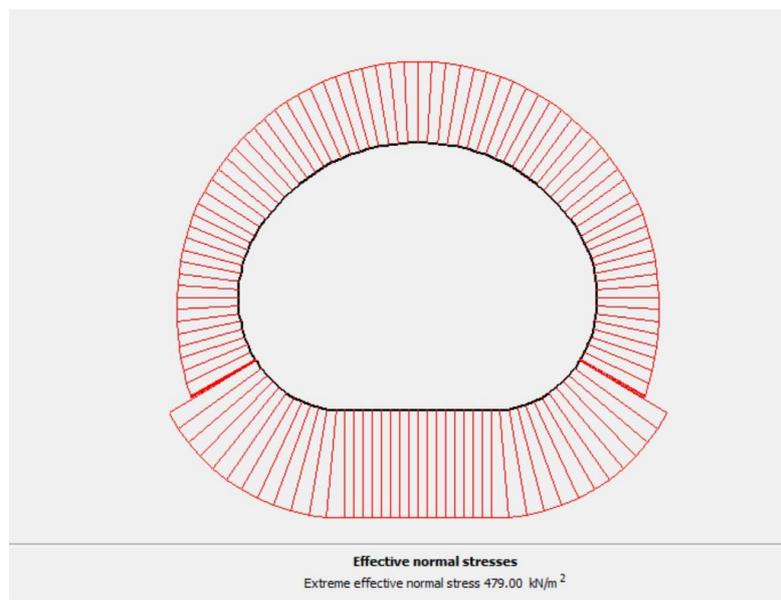
**Figure 6.29- diagramme de l'effort normal (valeur maximal  $\sigma_s = 479 \text{ Kpa}$ )**
