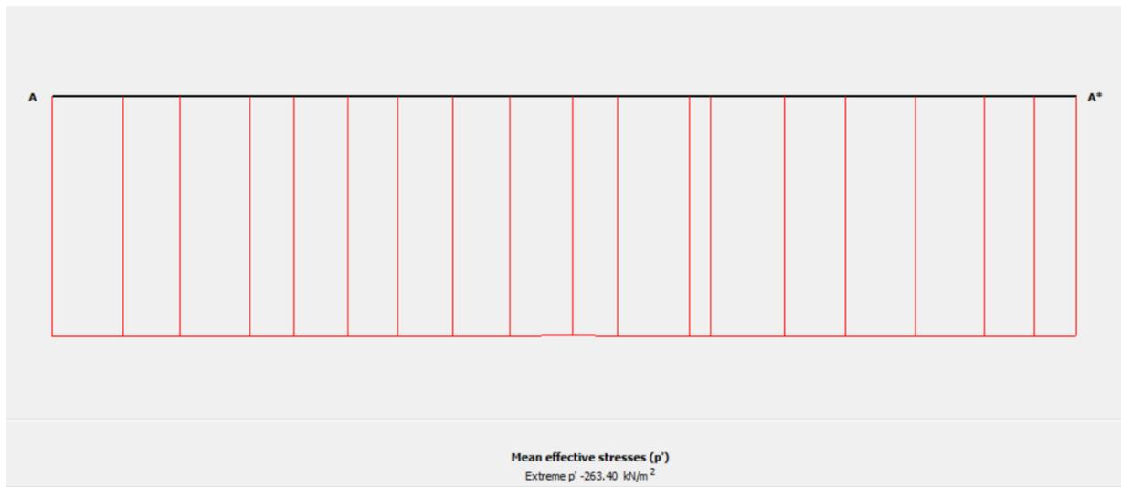
**Figure 6.32- Diagramme de la pression verticale moyenne agissant sur le soutènement provisoire sur la coupe A-A' Pmax = 263.40 KPa dans la phase-01 de calcul.**
