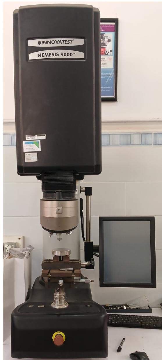
FIGURE 4.9 – Duromètre
