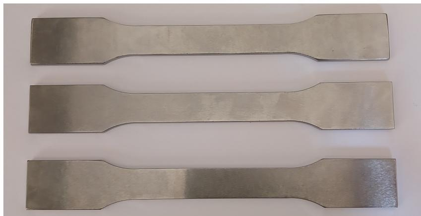
FIGURE 4.4 – Éprouvettes plates pour les essais de traction
