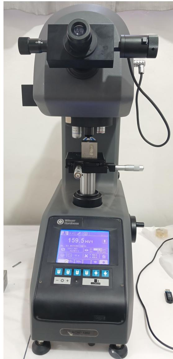
FIGURE 4.7 – Microduromètre TUKON 1202 de Wilson Hardness
