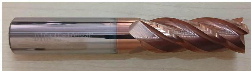
FIGURE 4.13 – Fraise cylindrique à deux tailles
