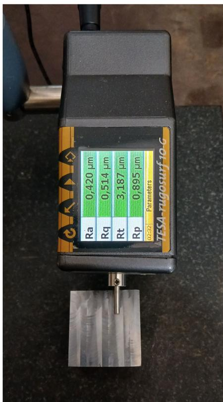
(a) Mesure dans le sens de l'avance de l'outil - paramètre Ra affiché
