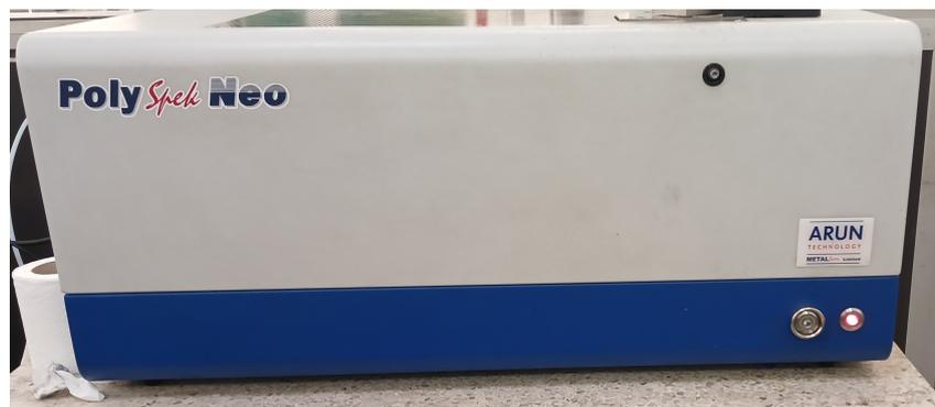
FIGURE 4.1 – Spectromètre d'émission optique par étincelle Poly Spek Neo
