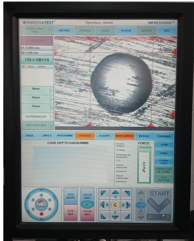
(b) Écran du duromètre montrant l'empreinte du pénétrateur Brinell observée au microscope ( $\times 10$ )
