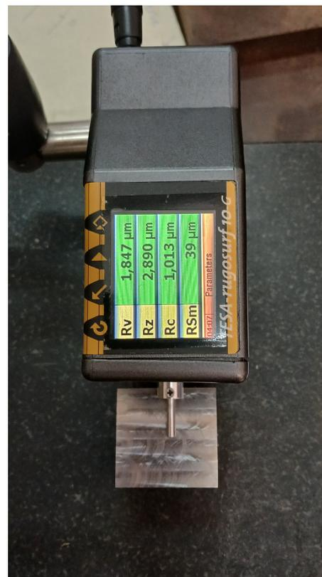
(b) Mesure le sens de perpendiculaire au sens d'avance de l'outil - paramètre Rz affiché
