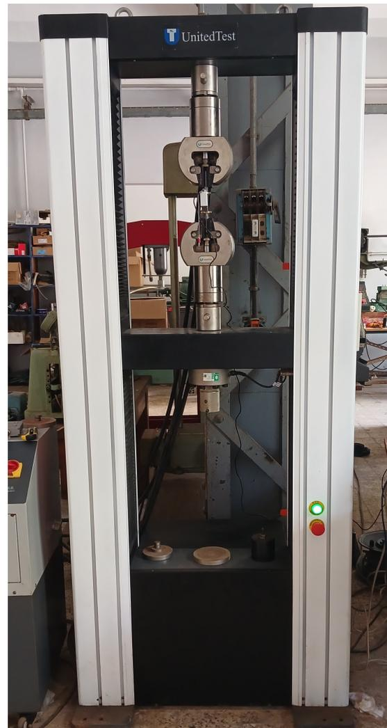
FIGURE 4.5 – Machine universelle électromécanique d'essais mécaniques de capacité de 100 kN
