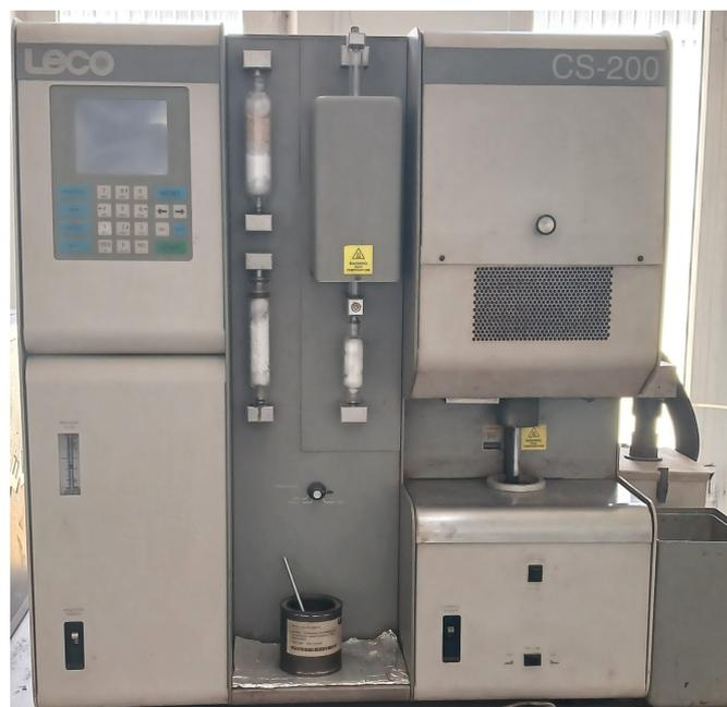
FIGURE 4.3 – Analyseur élémentaire par combustion LECO CS-200
