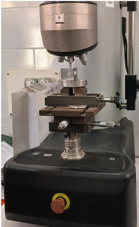
(a) Montage de l'essai HB : échantillon positionné sous le pénétrateur
