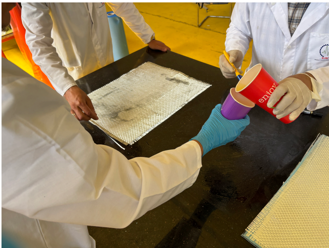
FIGURE 3.1 – Imprégnation manuelle de chaque couche avec de la résine époxy
