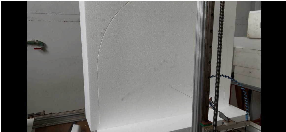
FIGURE 5.4 – Découpe du bloc de mousse par fil chaud selon le tracé défini
