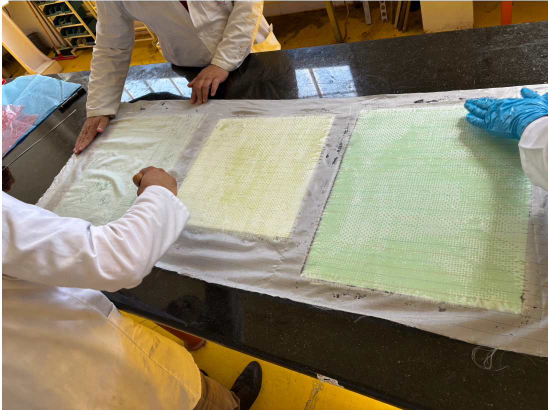
FIGURE 3.3 – Application d'un filet de drainage .
