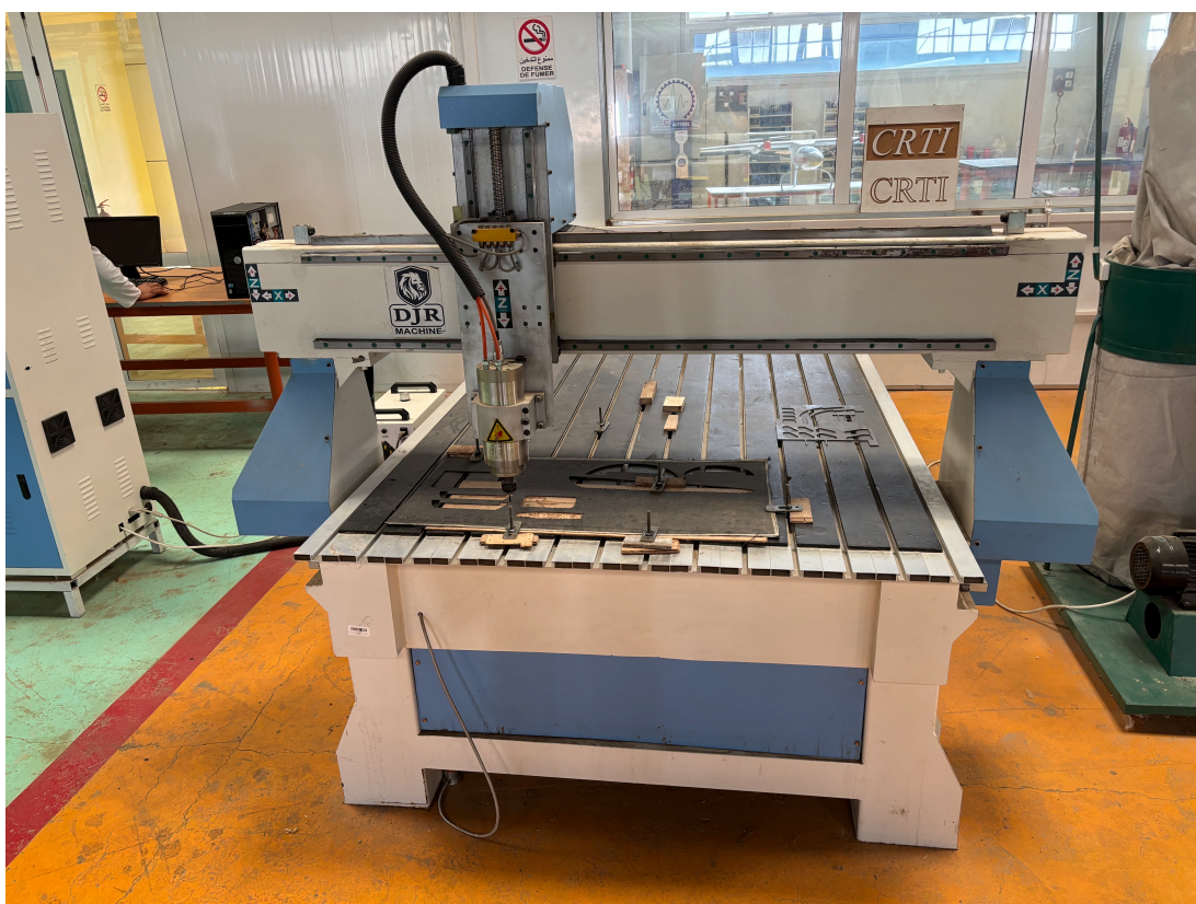
FIGURE 3.6 – Découpe précise des éprouvettes à l'aide d'une machine CNC à commande numérique.
