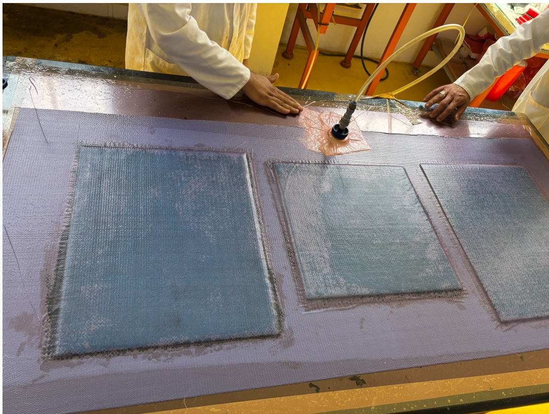
FIGURE 3.5 – Mise sous vide de l'ensemble à l'aide d'une pompe et d'un sac étanche.
