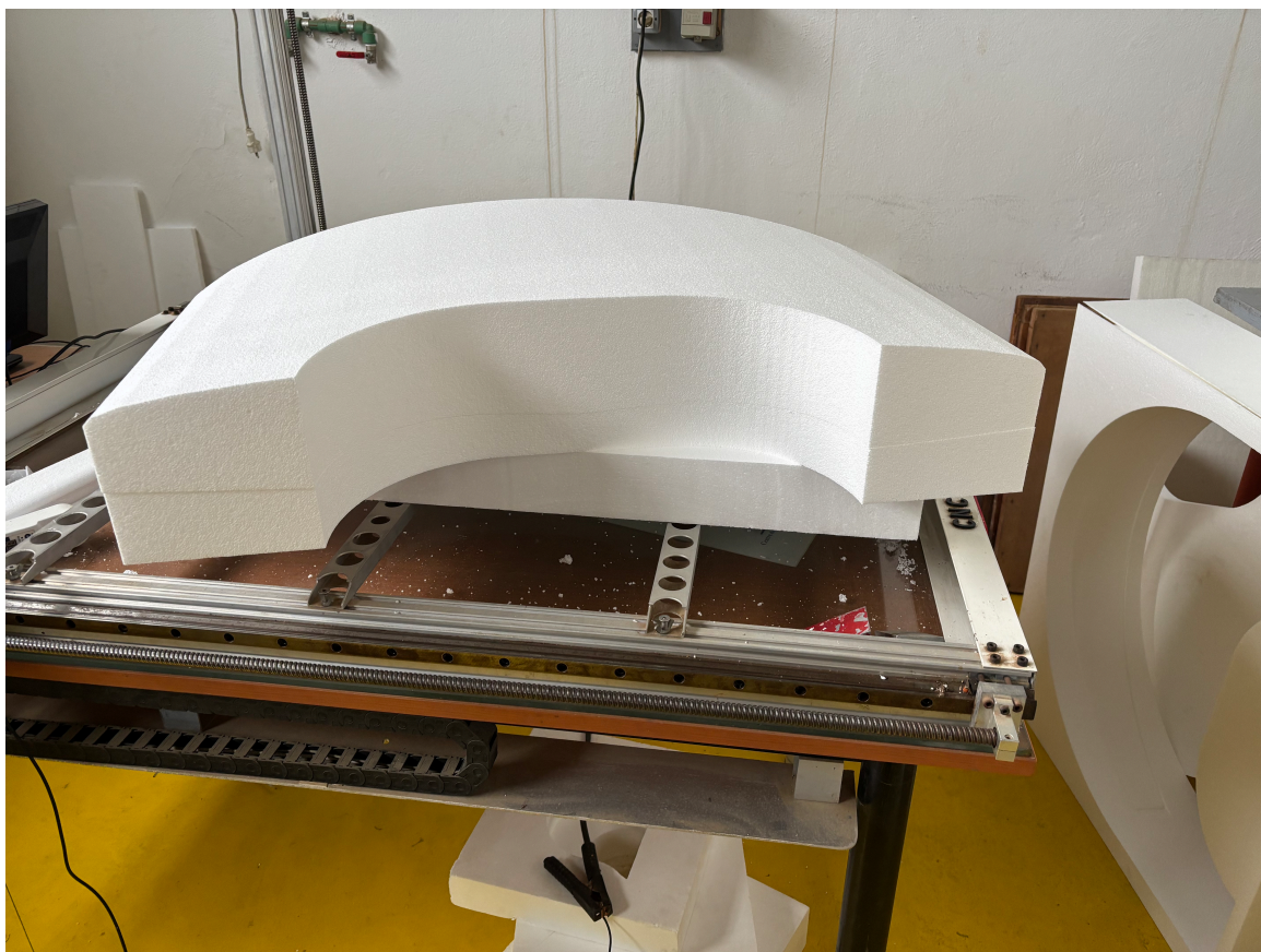
FIGURE 5.7 – Moule assemblé représentant le volume extérieur de la coque
