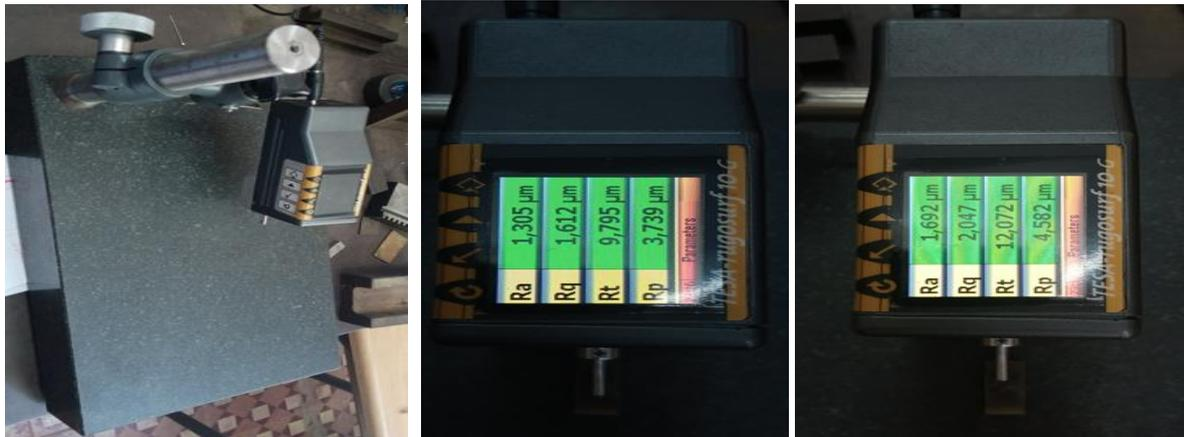
**Figure III. 31** Mesure de la rugosité de surface avec un rugosimètre.
