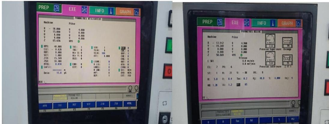
Figure III. 25 Vérification des paramètres technologiques (vitesse, intensité, pression de rinçage, etc.).
