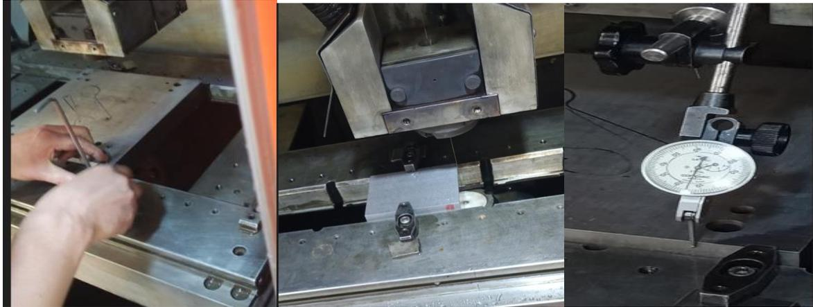
Figure III. 23 Montage de la pièce à usiner sur la table de la ROBOFIL 290P.
