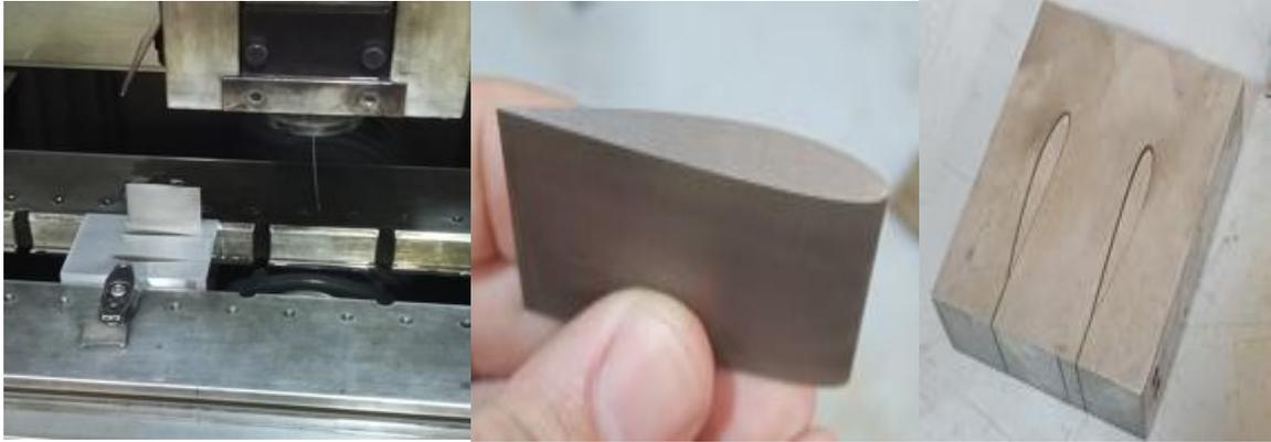
**Figure III. 43** Fin d'usinage et nettoyage de la pièce usinée (profil NACA 2412).
