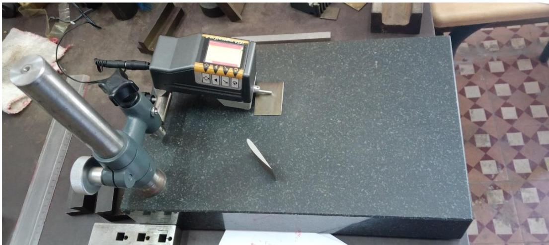
**Figure III. 44** Mesure de la rugosité de surface du profil NACA 2412 à l'aide d'un rugosimètre.
