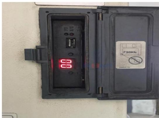
**Figure III. 22** Processus de transfert du fichier G-code vers la machine ROBOFIL 290P via une clé USB.
