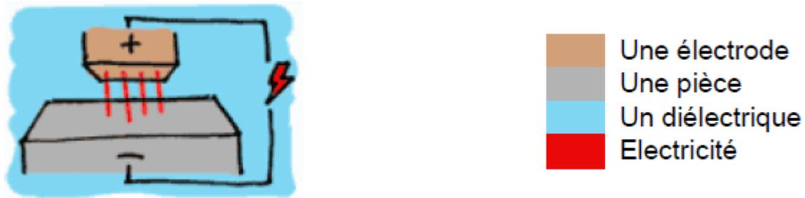
**Figure I. 2** Équipement d'usinage par EDM [3].
